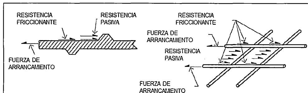
Figura N° 2.18. Resistencia pasiva o trabazón
