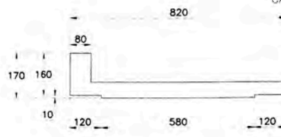
SECCION FRONTAL DE TAPA DE CANALETA CENTRAL
