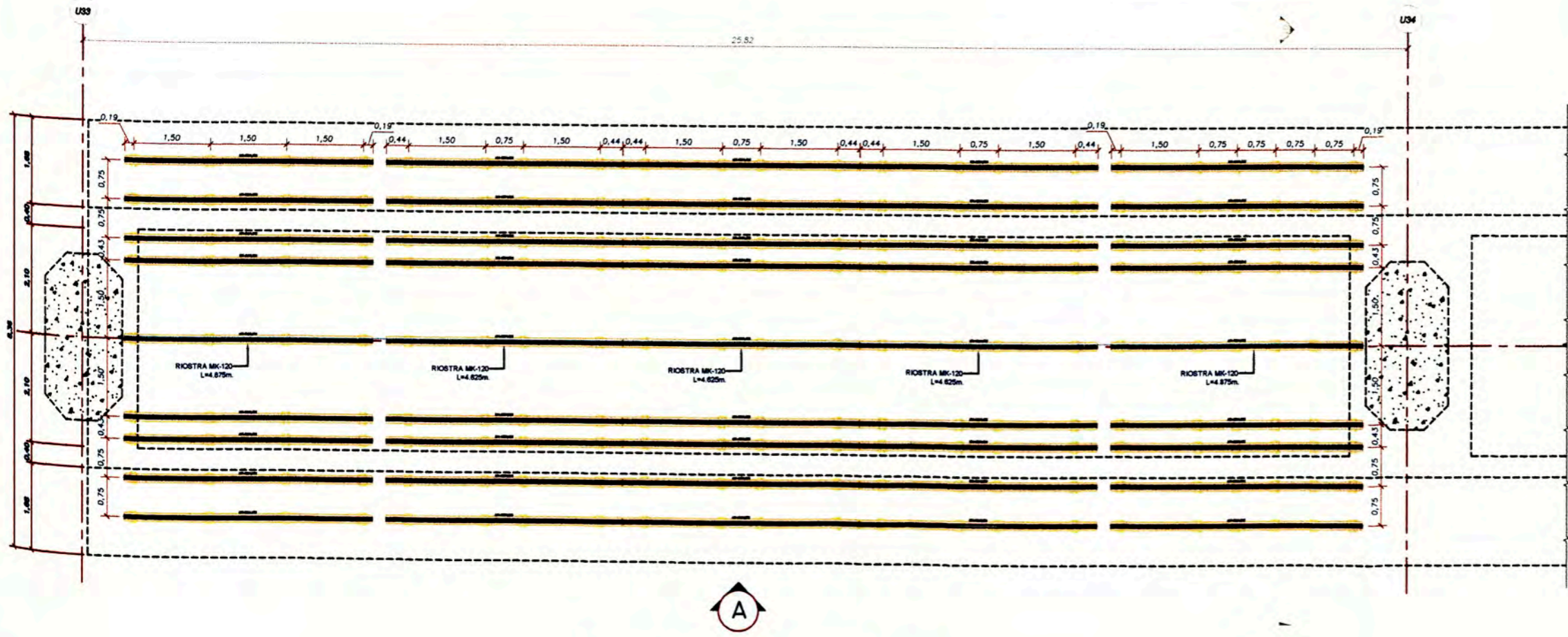
DISTRIBUCIÓN DE VIGAS PRIMARIAS 01 - MK-120
