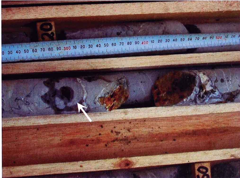
Foto 37: Testigo del taladro RP-P7v (profundidad 97.5 m aprox.); notar la cavidad de disolución de 10 mm de diámetro y oxidación (indicativo de flujo de agua subterránea).
