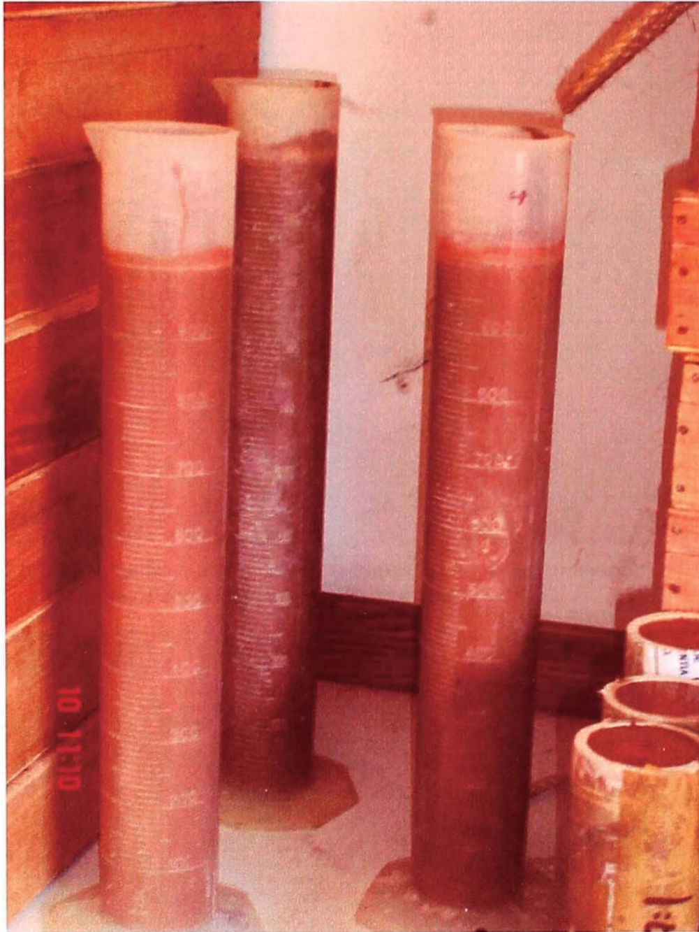
Foto 33: Ensayo de Sedimentación. Decantación del agua libre en la parte superior de una probeta graduada de 1000 ml.
