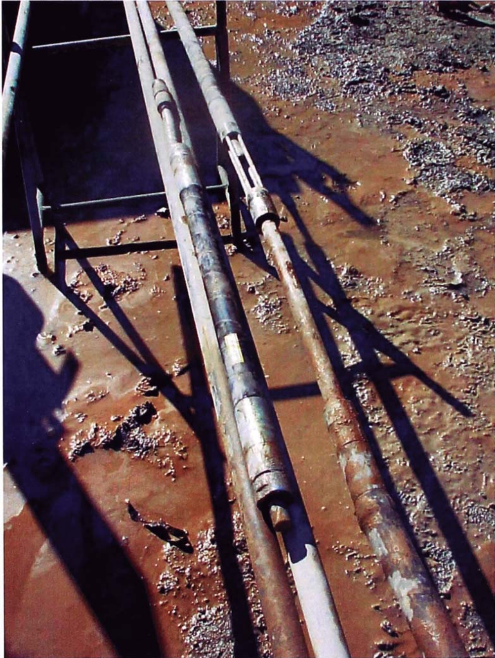
Foto 21: Obturadores Simple y Doble de diámetro HQ inflados con nitrógeno para aislar tramos específicos durante las inyecciones y pruebas de agua.
