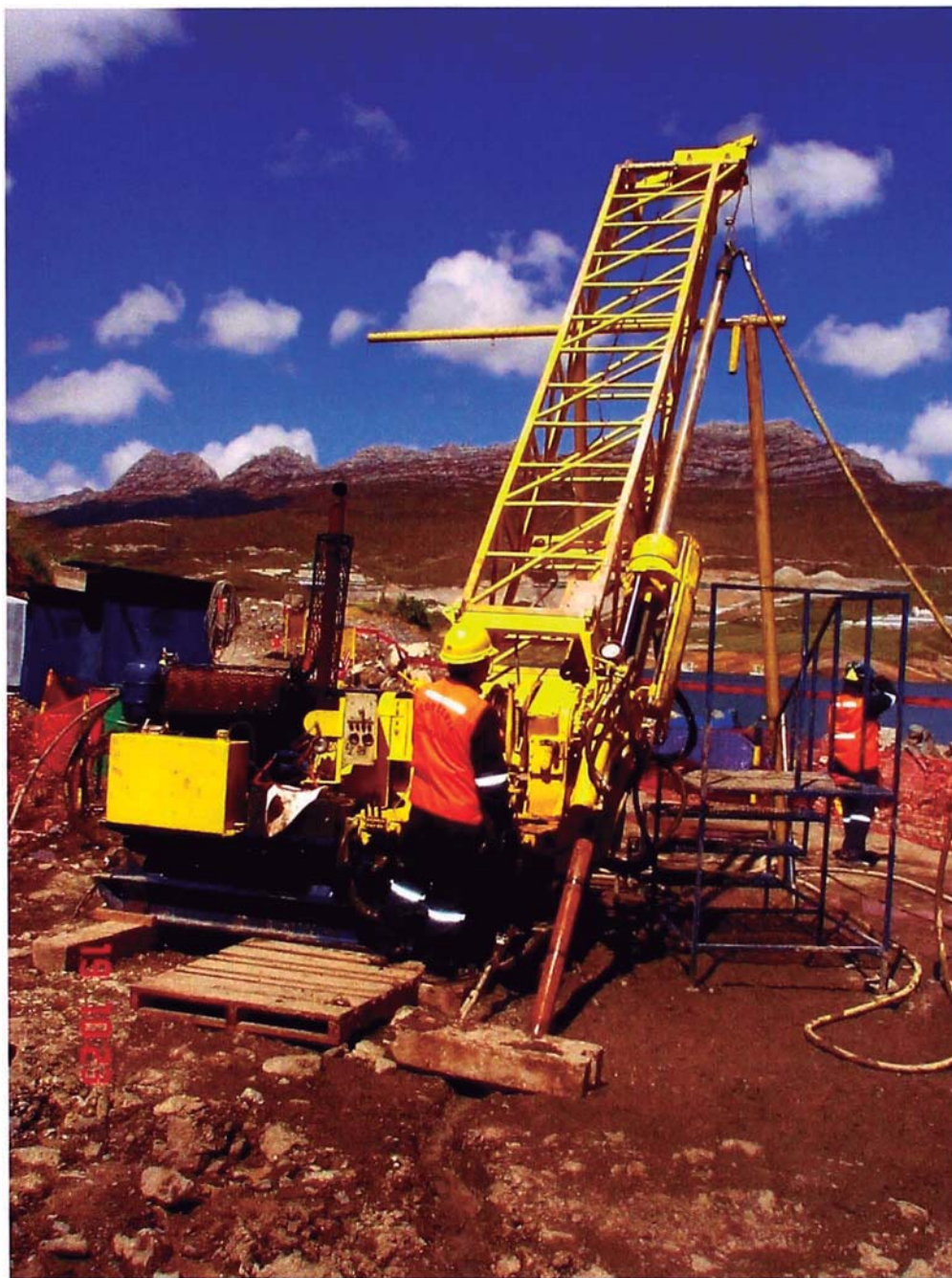
Foto 14: Perforadora Longyear LY-38. Perforación diamantina con recuperación de testigos del taladro exploratorio GA06-01.
