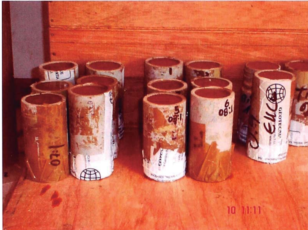
Foto 34: Testigos de mezclas tomados para la determinación de la resistencia a la compresión no confinada (UCS).
