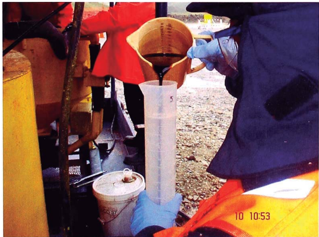
Foto 27: Medición cuidadosa del Superplastificante Euco 37 usando una probeta graduada de 1000 ml.
