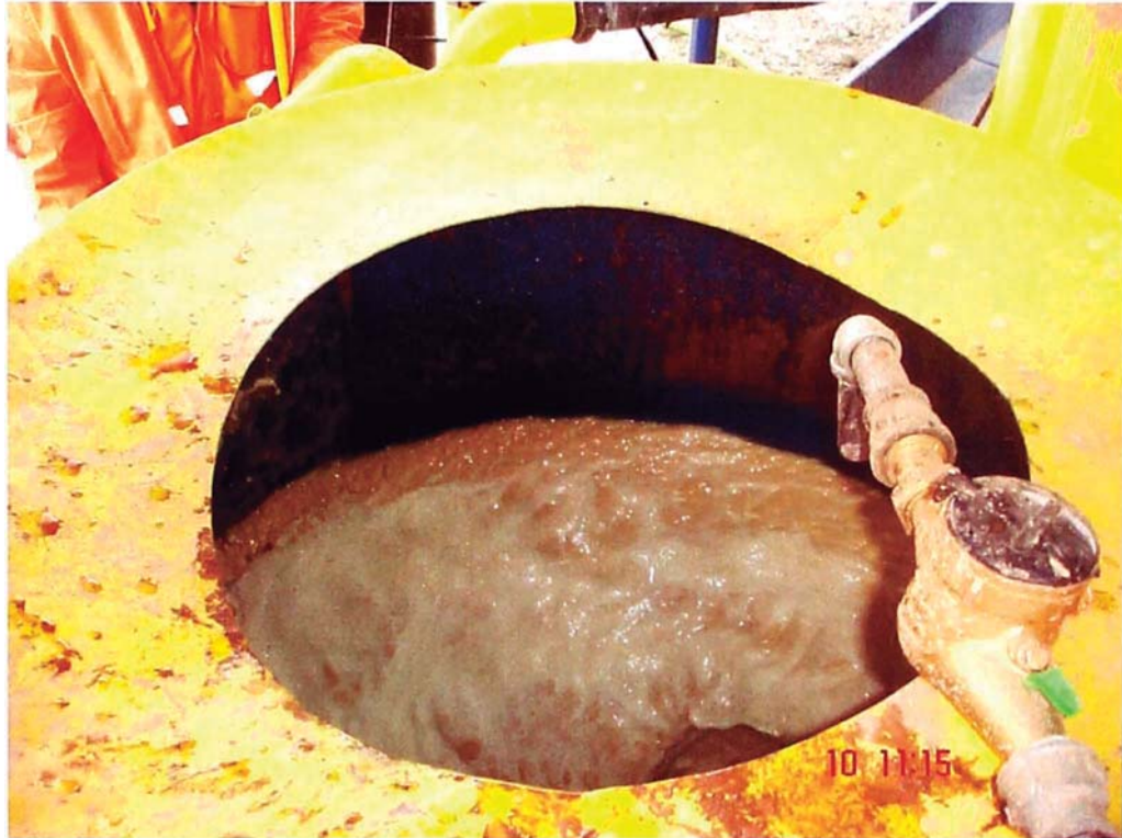
Foto 26: Caudalímetro de ½" de diámetro para medir el volumen de agua en la preparación de mezcla
