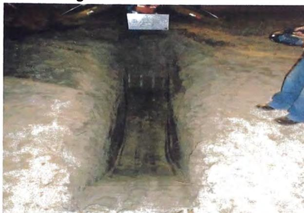
En cada una de las calicatas excavadas se obtuvieron muestras disturbadas representativas de cada capa del pavimento existente así como de cada estrato del terreno encontrado para la ejecución de los ensayos de laboratorio correspondientes a la determinación de las características físicas de los suelos.
