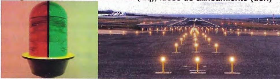
En cuanto a las luces del sistema PAPI (L-880, especificaciones FAA), esta se encuentra constituida por cuatro elementos ubicados normalmente al lado izquierdo de la pista (vista en el sentido de la aproximación) el color que producen las luces indicarán la pendiente de aproximación, esta será correcta cuando dos de estas muestren color blanco y las otros dos color rojo, como se muestra en la Figura N°8.5 y N°8.6.
