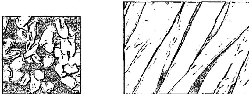
Figura 2.5. Vista transversal (Izq) y longitudinal (Derecha) de la fibra de algodón
