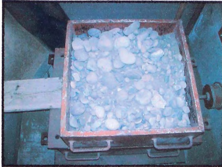
Figura 4.10. Suelo gravoso conformado en la caja de corte. Se observa la no uniformidad en la cara superior de la muestra.
