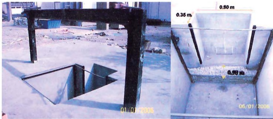
Figura 3.4. a), y b) Vista general de la implementación del pozo de ensayo acondicionado para el equipo de Corte Directo a Gran Escala.
