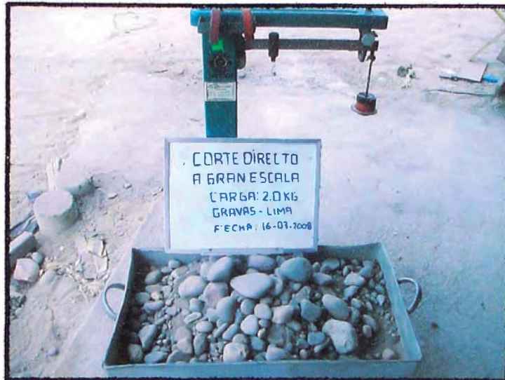
Figura 4.7. Balanza mecánica de 160 kilos de capacidad, utilizada para controlar el peso del suelo gravoso a conformarse en la caja de corte de acuerdo a la densidad requerida.
