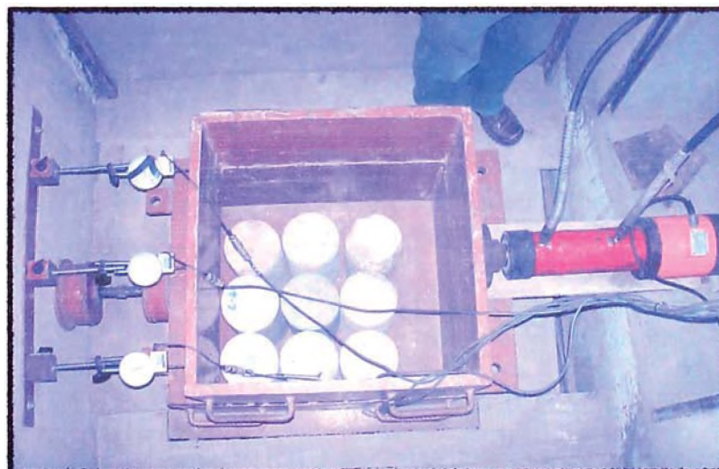
Figura 3.15 Aplicación de la fuerza tangencial a la caja de corte sin muestra.
