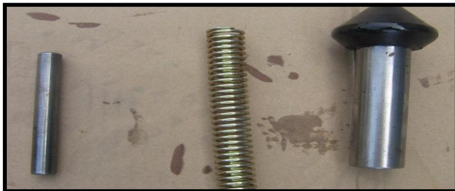
Figura 4.29 válvula check para martillo Numa de 6''
