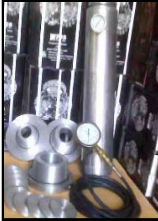
Figura 4.15. Herramientas para medir el caudal de aire
