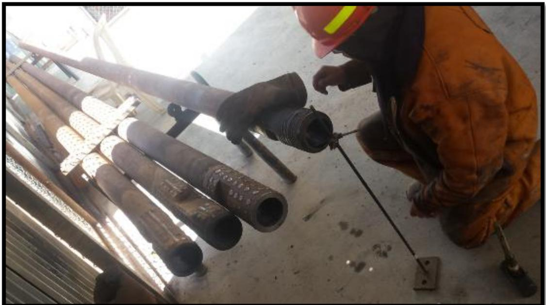
ANEXO 6: Barra de perforación revestida con Exatub y Citodur
