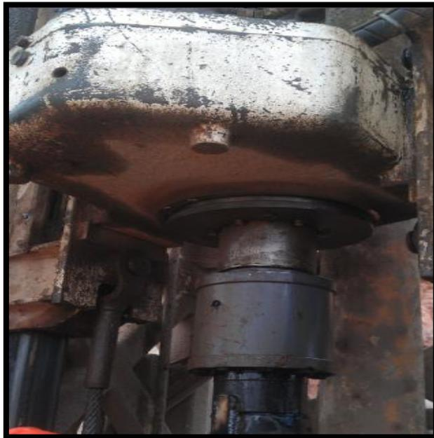
Figura 5.0 amortiguador de impacto de la SKF-11
