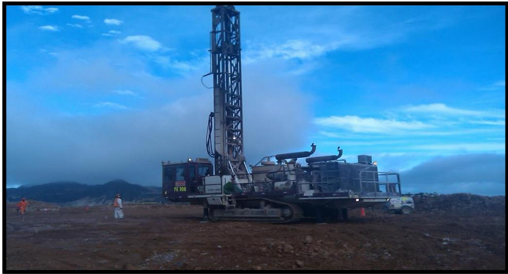
Figura 0.1- Perforación DTH tajo SPS
