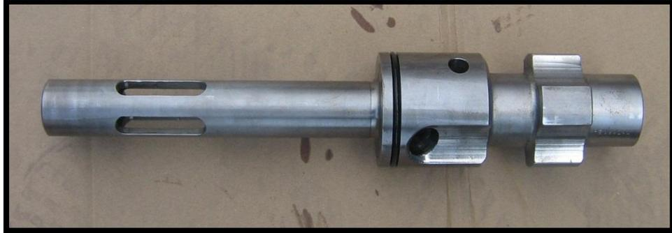
Figura 4.30 distribuidor de aire para martillo Numa de 6''
