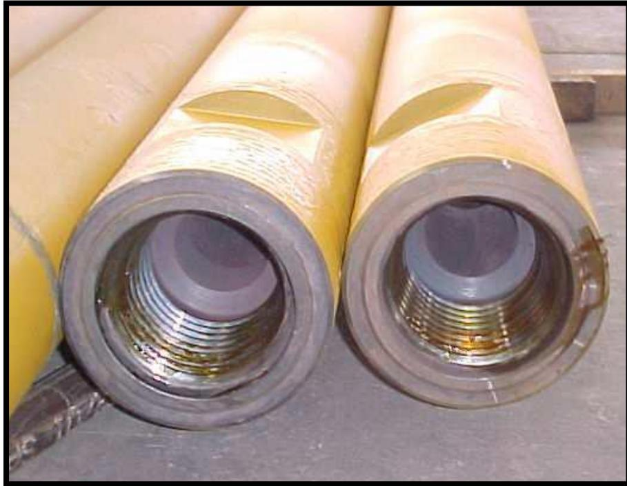
Figura 5.3 barra de perforación box-box con flat
