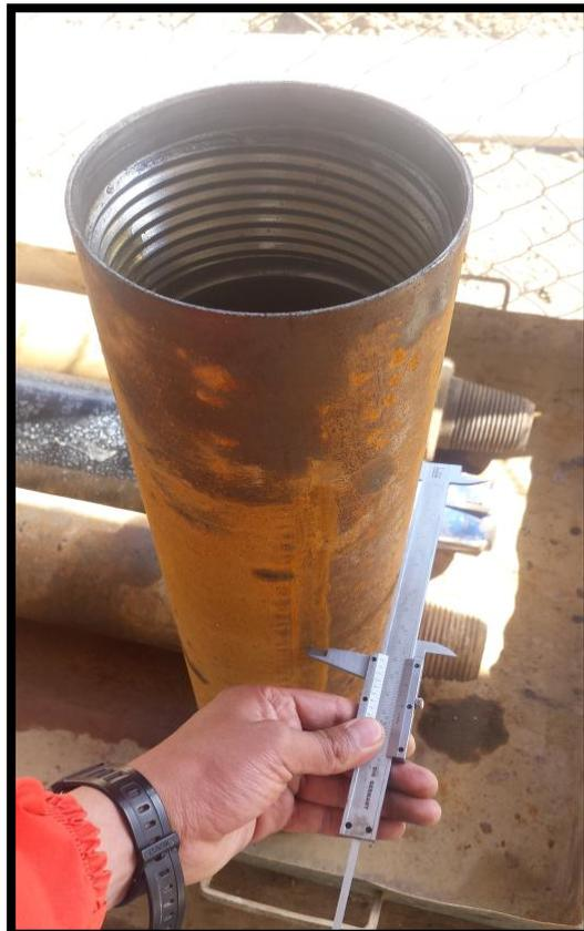
Figura 0.3 medición del diámetro del martillo DTH
