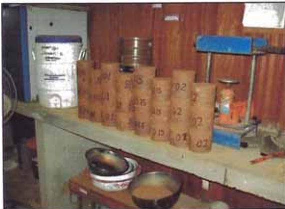
Foto 08. Moldeo de especímenes para el ensayo de humedecimiento y secado.
