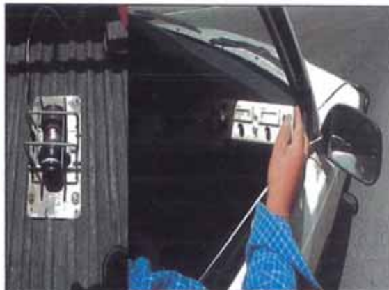
Foto 40. Medición de la rugosidad superficial a nivel de TSB con el equipo de tipo respuesta Bump Integrator.
