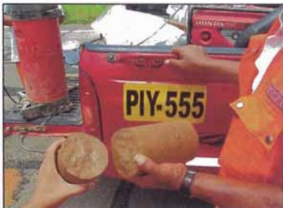
Foto 49. Obsérvese en el núcleo diamantino, la presencia de sílice que aporta en la reacción puzolánica del suelo cemento.
