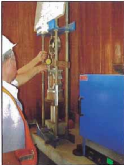
Foto 34. Ensayo de Tracción en suelo cemento simulando la norma de tracción indirecta del concreto (MTC E 708, ASTM C 496).
