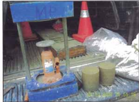
Foto 05. Especímenes de suelo-cemento que serán curado a los 7 días en cámara húmeda para su posterior rotura a la compresión simple.
