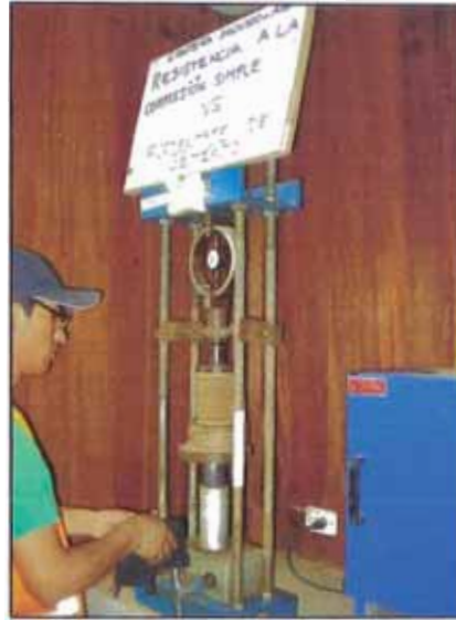
Foto 33. Especimen sometido al ensayo de compresión simple no confinada (MTC-1103, ASTM D 1633) previo capping.
