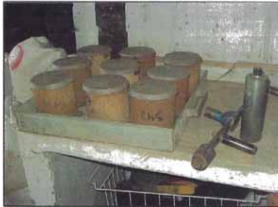
Foto 07. Especímenes de suelo cemento capeado para las rotura a la compresión simple.
