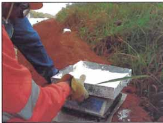
Foto 11. Verificación de la tasa de cal in situ ( kg/m^2 ), por el método de bandeja.
