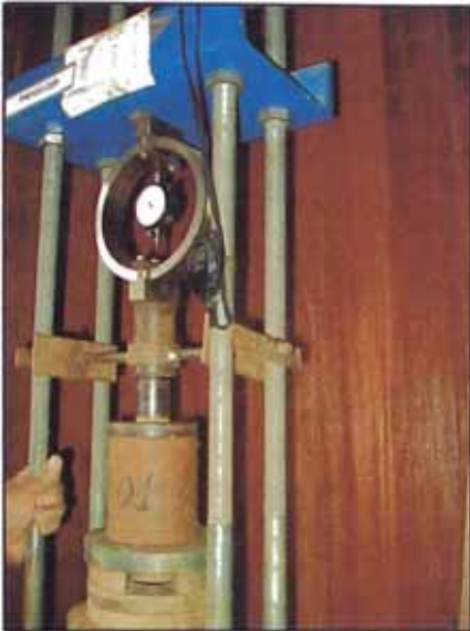
Foto 06. Resistencia a la compresión simple no confinada del espécimen (Método A).
