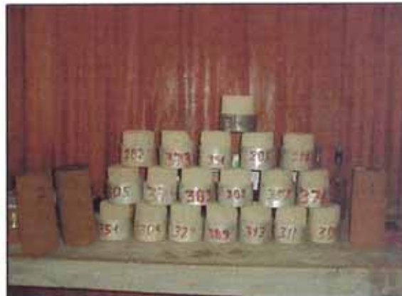
Foto 09. Especímenes con distintas tasas de cemento luego de los 12 ciclos del ensayo de humedecimiento y secado.
