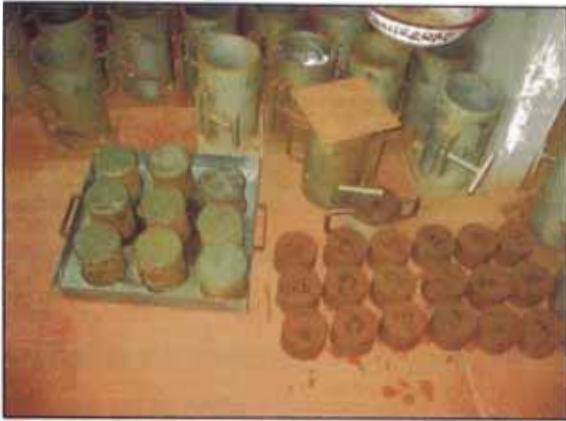
Foto 32. Batería de especímenes de suelo cemento para el ensayo de compresión simple y tracción indirecta.
