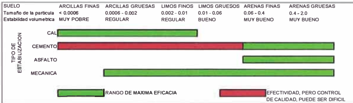
Fig. 4-2: Aplicabilidad de los métodos de estabilización (Ingles y Metcalf, 1972)
