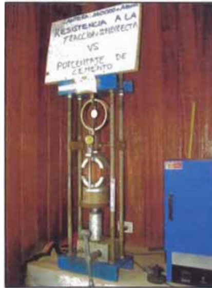
Foto 35. Vista del especimen colocado en la mordaza para ser sometido al ensayo de Tracción indirecta.
