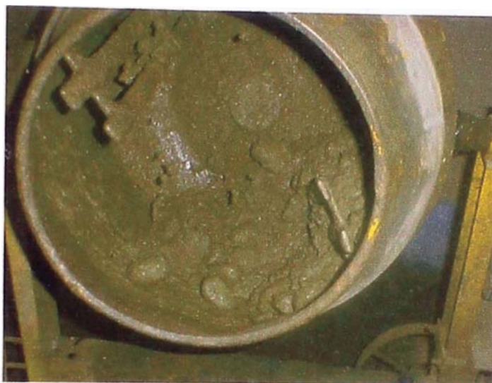
MEZCLA DE CONCRETO CON AGREGADO DE PERFIL REDONDEADO
