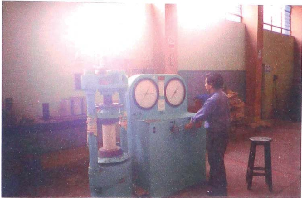
ENSAYO DE RESISTENCIA A LA COMPRESION
