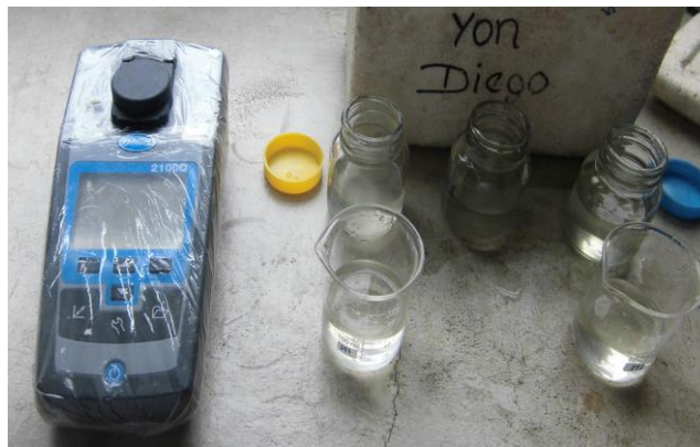
Figura 13 Medición de la turbiedad con el turbidímetro 2100Q de la marca HACH.
