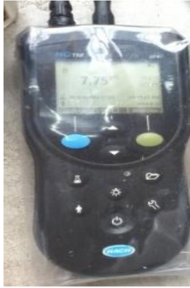
Figura 12 Medidor portátil HQ11d de la marca HACH, para pH y Temperatura.
