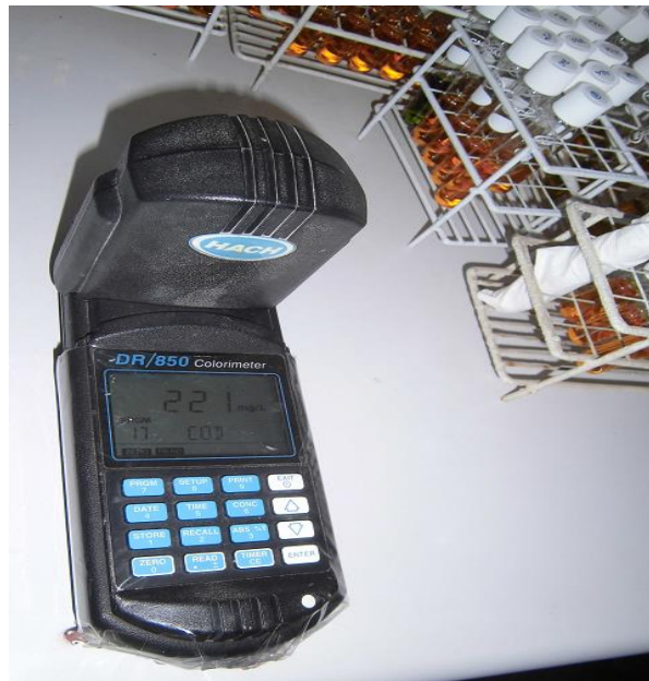
Figura 11 Colorímetro DR/850 marca HACH, utilizado para la medición de la DQO.
