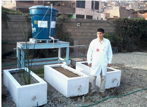
Figura 6 Crecimiento de la macrófita en el periodo de arranque de la primera etapa
