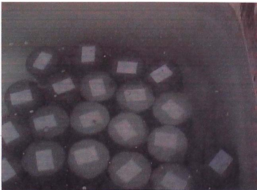
Siempre debemos tener en cuenta que el nivel de agua debe ser mayor que el de las probetas.
