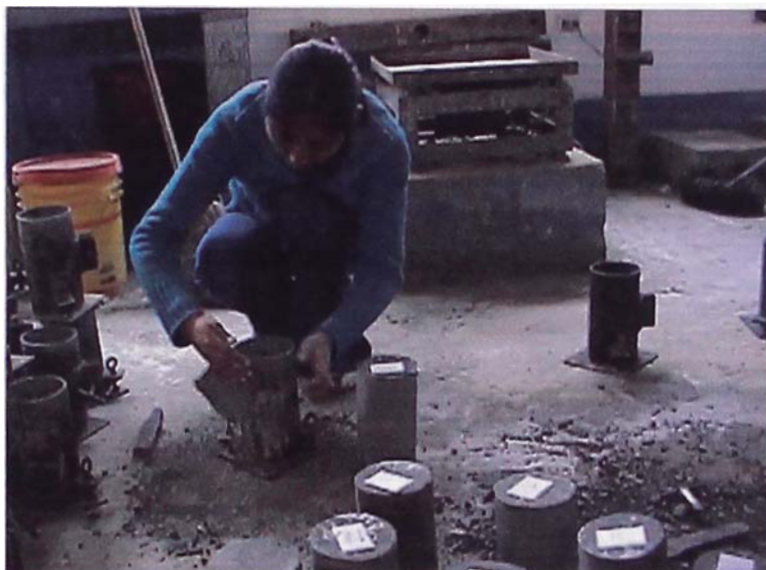
Se limpió y luego se engrasó las probetas.
