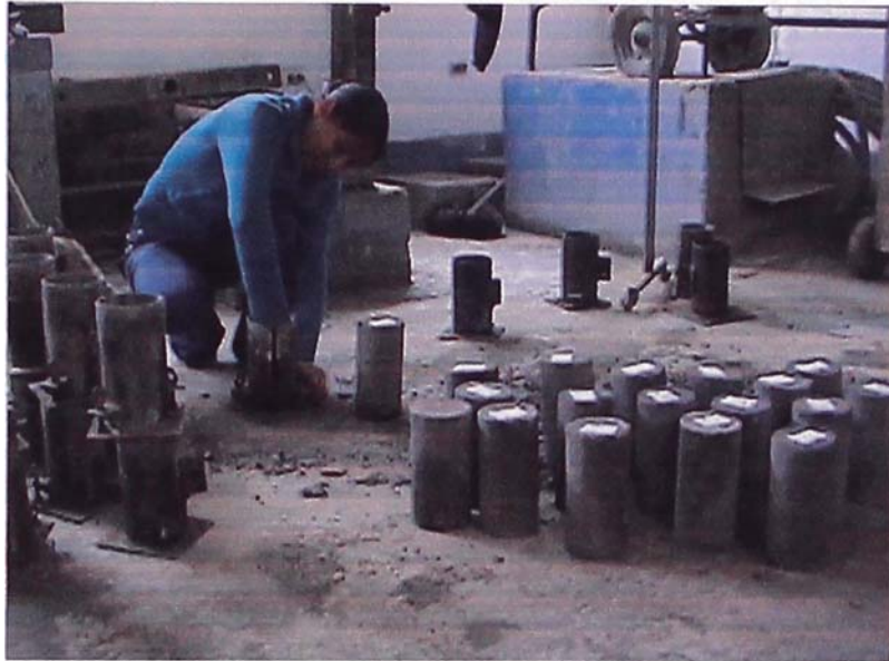
Se desencofró las probetas para luego llevarlas a curar.
