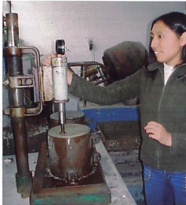
Tomando datos para calcular el tiempo de Fraguado
