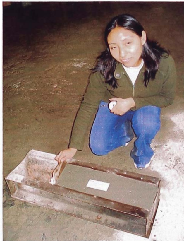
Realización de vigas de 15 x 15 x 50 cm
