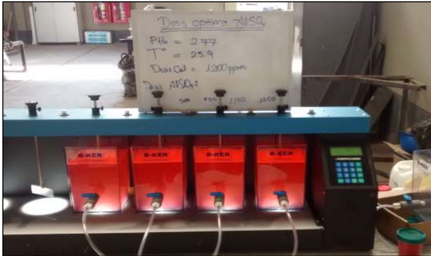
Figura 5.27. Pruebas para dosis optima de sulfato de aluminio.
