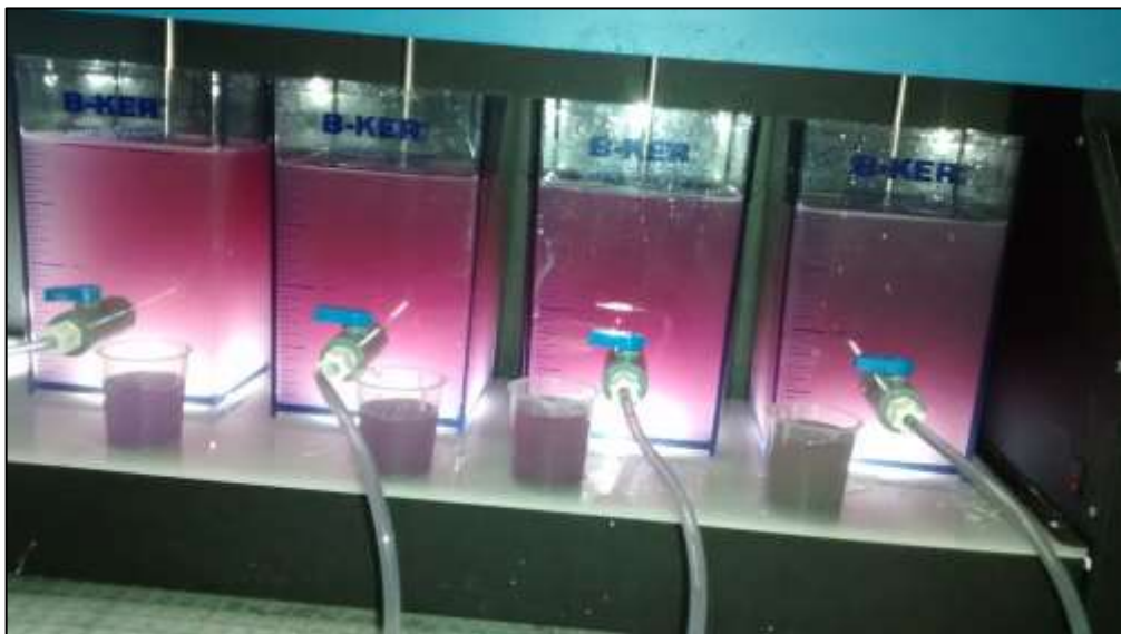
Figura 5.19. Prueba de jarras con segundo rango de Hidróxido de calcio.
