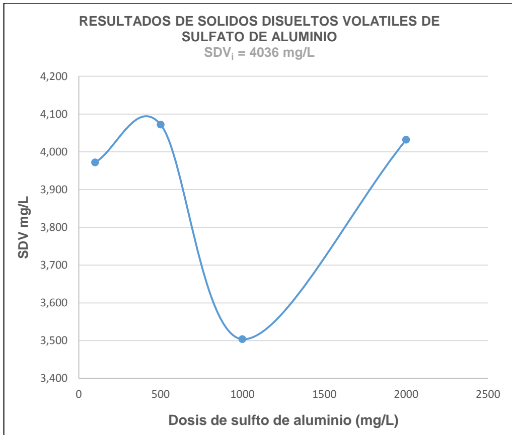
Figura 5.9. Resultado de S.D.V. según dosis de sulfato de aluminio.
