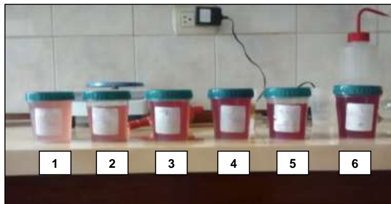
Figura 4.13. Muestras de agua tratada con Cloruro de férrico.
