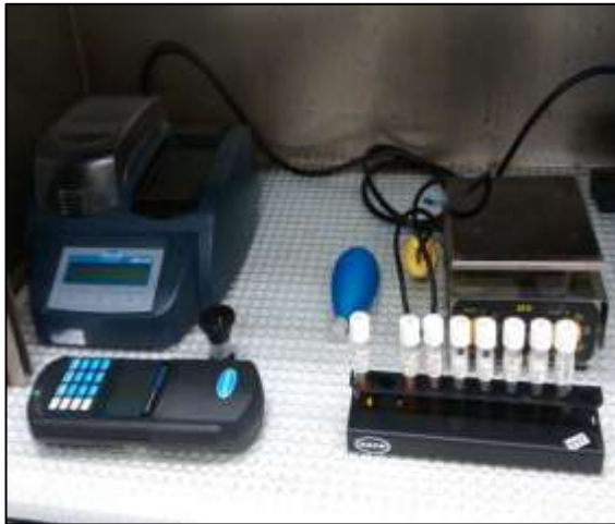
Foto N°7: Materiales y equipos para medición de DQO.
