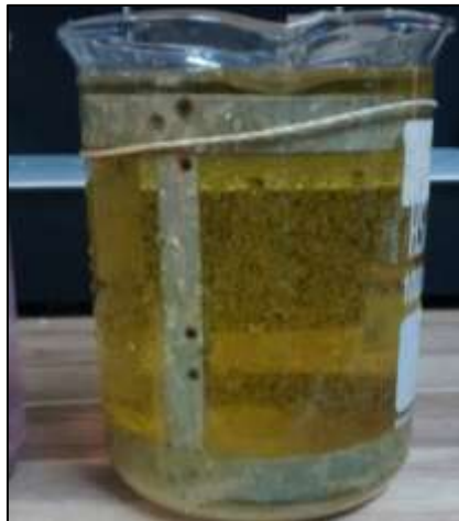
Figura 4.21. Generación de solidos suspendidos con Hidróxido de calcio.
