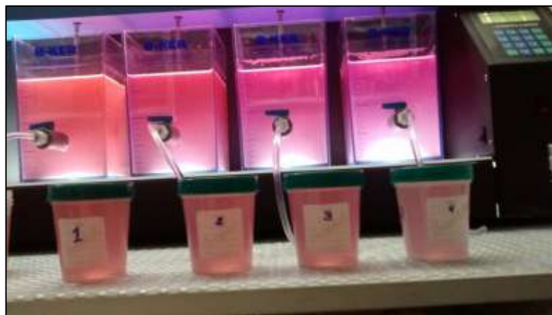
Figura 5.18. Agua residual tratada con primer rango Hidróxido de calcio.
