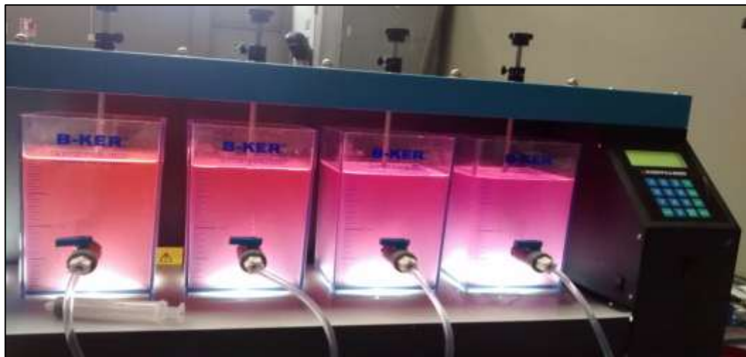
Figura 5.17. Prueba de jarras primer rango de Hidróxido de calcio.
