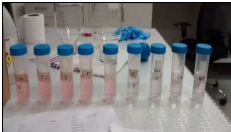
Figura 5.22. Prueba de jarras con Sulfato de aluminio e Hidróxido de calcio.
