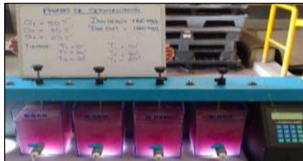
Figura 5.50. Inicio de la prueba de sedimentación.
