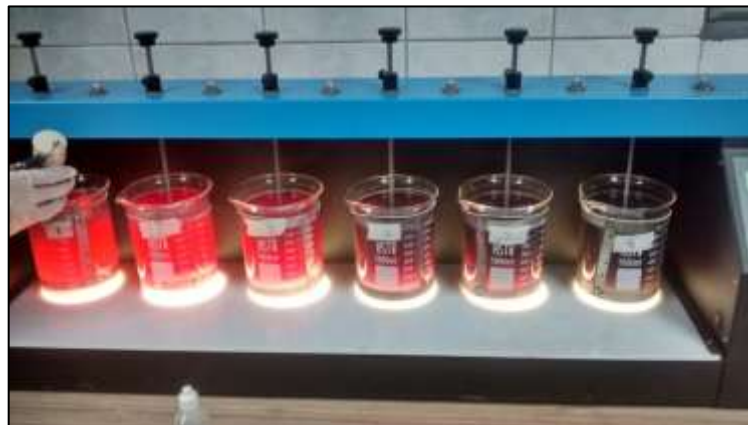
Figura 4.10. Prueba de jarras con Cloruro de férrico.
