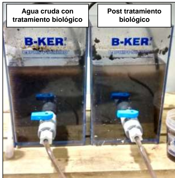
Figura 5.67. Sedimentación en el proceso biológico (2 min).
