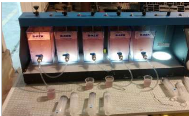
Figura 5.31. Pruebas para parámetros óptimos de Floculación.
