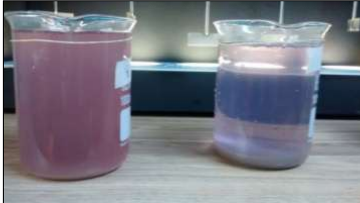
Figura 4.20. Muestras de agua tratada con Hidróxido de Calcio.
