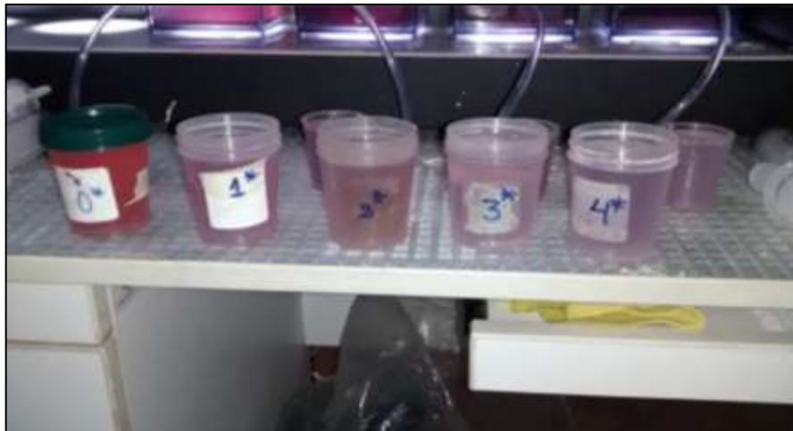
Figura 5.20. Agua residual tratada con segundo rango de Hidróxido de calcio.
