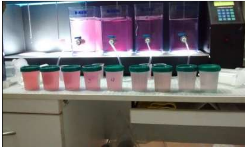
Figura 5.21. Agua residual tratada con Sulfato de aluminio e Hidróxido de calcio.
