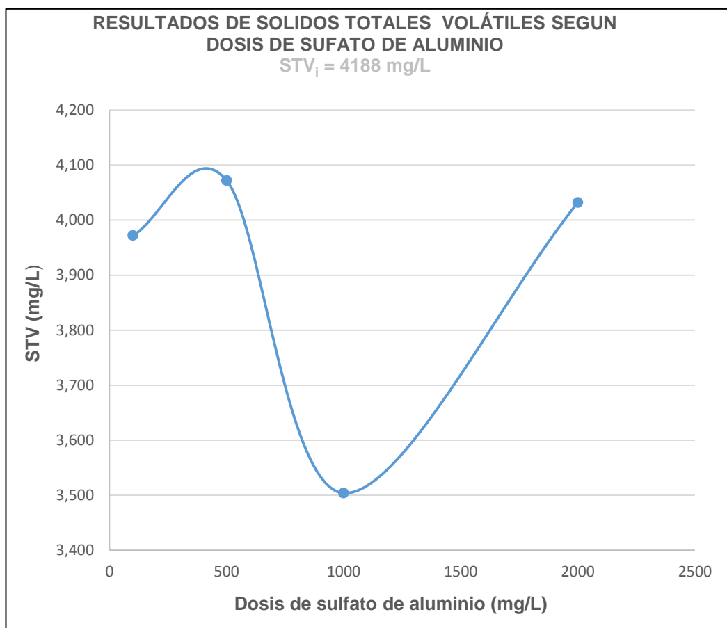
Figura 5.8. Resultado de S.T.V. según dosis de sulfato de aluminio.
