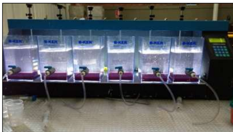
Figura 5.45. Parámetros óptimos de Floculación. ( G = 20, 35 y 50 \text{ S}^{-1} )
