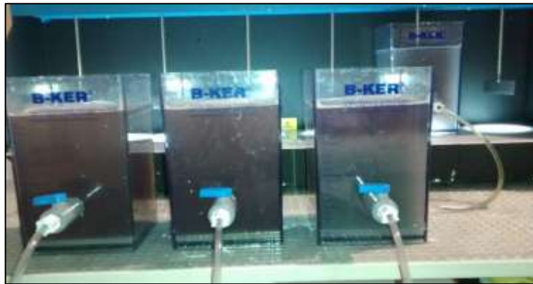
Figura 5.36. Pruebas para parámetros óptimos de Floculación ( G = 20 S^{-1} )
