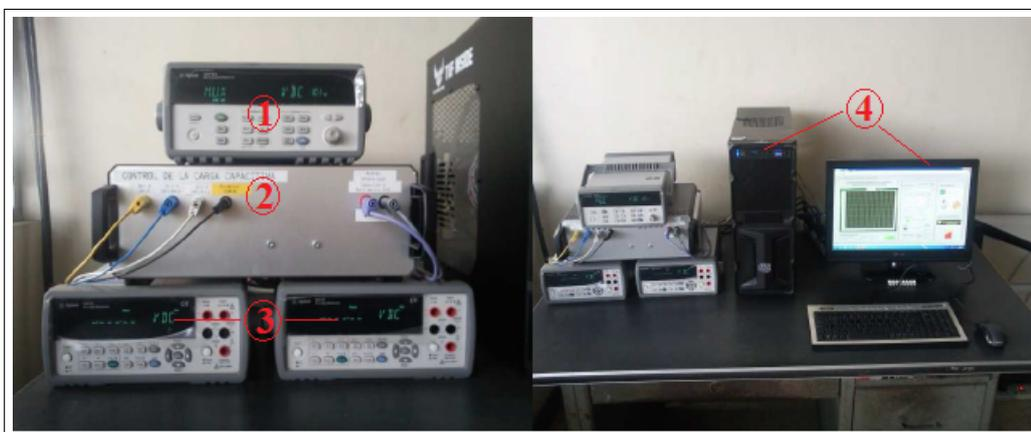
Figura 9: Instrumentos de medición y control ubicados en la oficina A1-255 de la Facultad de Ingeniería Mecánica. El sistema está constituido por: ① *data logger*, ② carga capacitiva, ③ multímetros digitales y ④ PC
