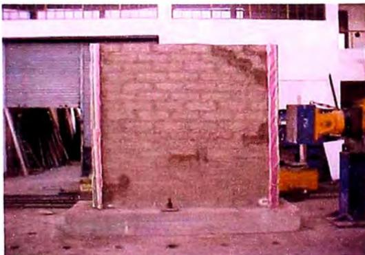
**Figura 104:** Muro reforzado con costalillo
