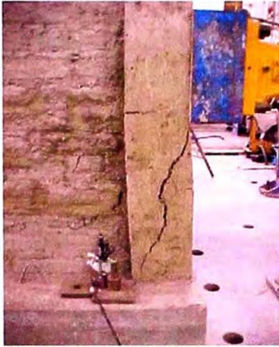
**Figura 112:** Muro reforzado con costalillo
