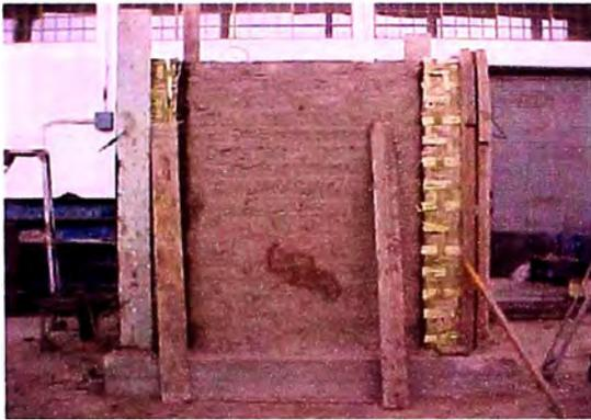
**Figura 100:** Muro reforzado con estera
