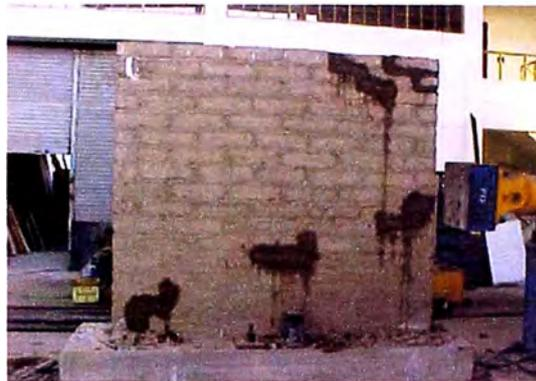
**Figura 89:** Muro parcialmente reparado
