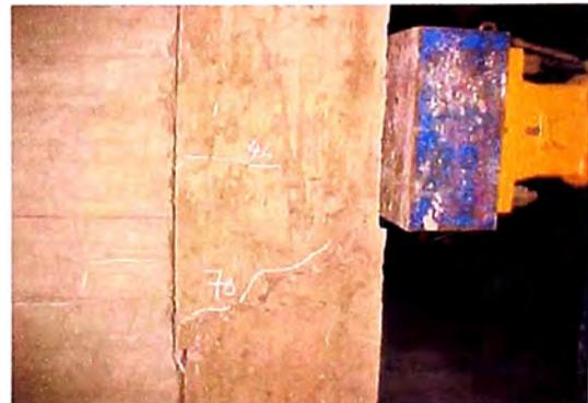
**Figura 111:** Muro reforzado con estera
