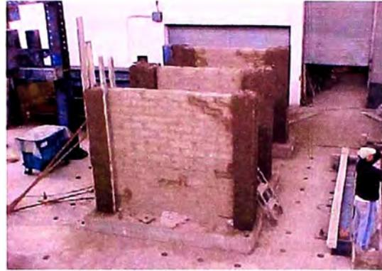
**Figura 107:** Muros reforzados terminados
