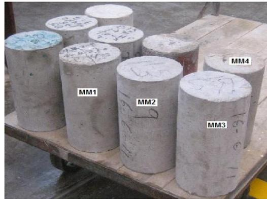
Figura 27. Probetas Fabricadas con el Concreto Usado en la Viga
