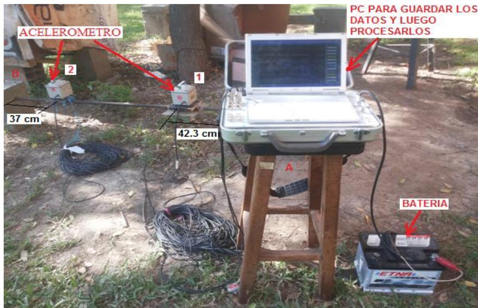
Figura 54. Disposición de los Equipos para Evaluar las Frecuencias en la Barra Empotrada en sus Dos Extremos con el Acelerómetro
