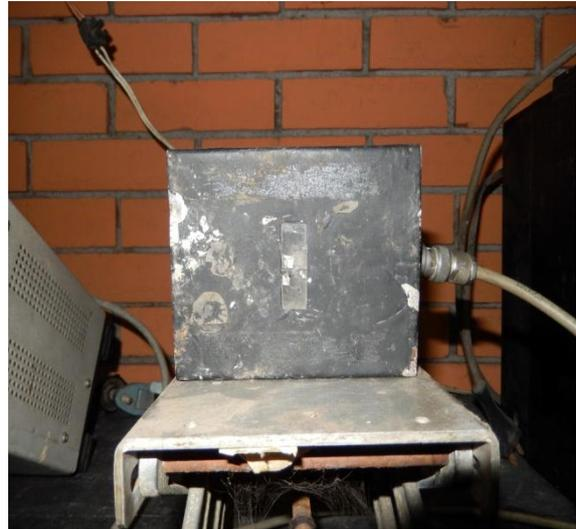
Figura 30. Fotocelda Utilizado para Evaluar Vibraciones con el Método LPD.
