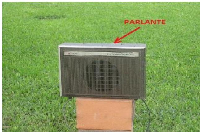
Figura 28. Parlante Utilizado para Evaluar Vibraciones con el Método LPD.
