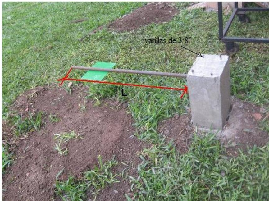
Figura 25. Dimensiones de la Barra Empotrada en un Extremo.
