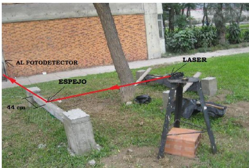
Figura 46. Disposición de los Equipos en la Viga Empotrada en sus Dos Extremos.
