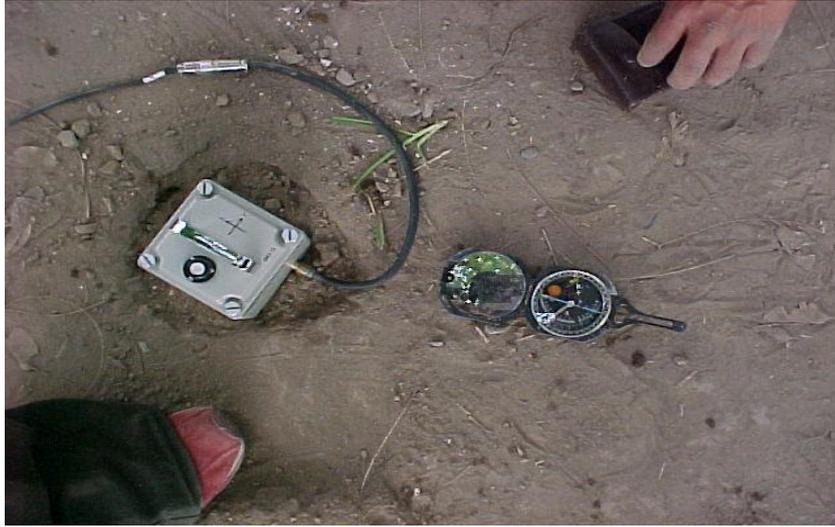
Figura 50. Acelerómetro Utilizado para la Evaluación de Datos.
