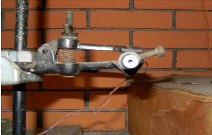
Figura 32. Laser Utilizado para Evaluar Vibraciones con el Método LPD
