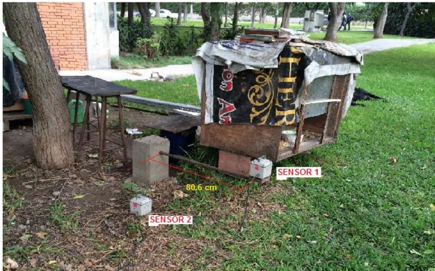
Figura 55. Disposición de los Equipos para Evaluar las Frecuencias en la Barra Empotrada en un Extremo con el Acelerómetro.
