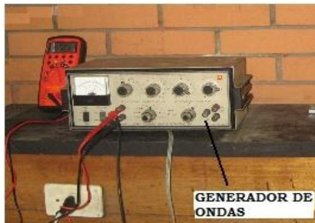
Figura 29. Generador de Ondas Utilizado para Evaluar Vibraciones con el Método LPD.
