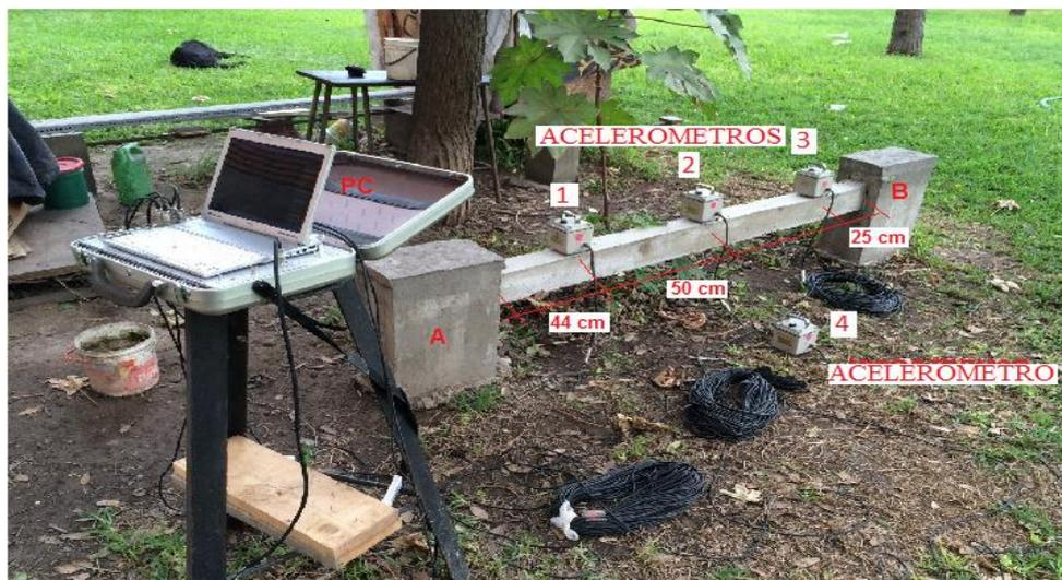
Figura 56. Disposición de los Equipos para Evaluar las Frecuencias en la Viga Empotrada en sus Dos Extremos con el Acelerómetro.
