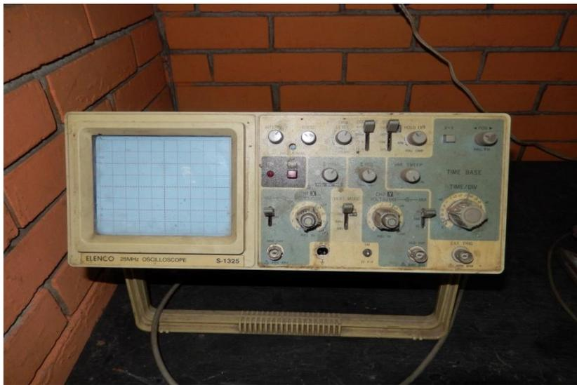
Figura 33. Osciloscopio Utilizado para Evaluar Vibraciones con el Método LPD
