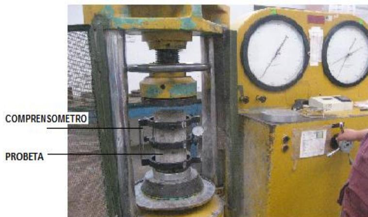
Figura 14. Ensayo para hallar el Modulo de Young del Concreto del Laboratorio de Ensayos de Materiales (LEM-FIC-UNI)
