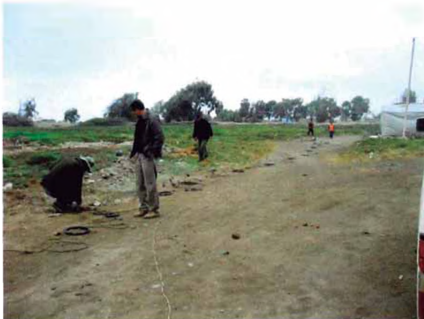
Fotografía No. 6. Vista panorámica de la línea sísmica del ensayo de MASW_08, en Pisco ( 13^{\circ}42'57.24'' S, 76^{\circ}12'46.91'' W). Se aprecia el tendido de la línea sísmica.
