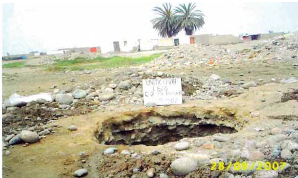
Fotografía No. 3. Calicata C-2, ubicada en la Zona de Expansión a la altura del Puente Polisaco (margen izquierda).
