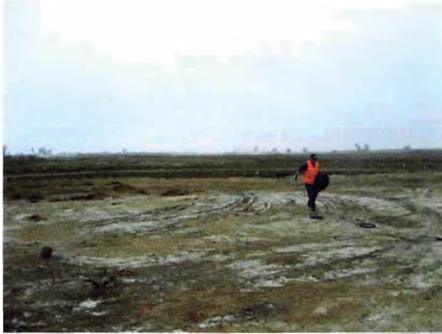
Fotografía No. 7. Vista panorámica del tendido de la línea sísmica del ensayo de MASW_09, cerca del muelle en Pisco ( 13^{\circ}42'40.7'' S, 76^{\circ}13'06.6'' W).
