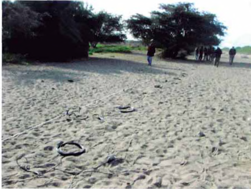
Fotografía No. 1. Vista panorámica de la línea sísmica del ensayo de MASW_02, en la Zona de Expansión ( 13^{\circ}44'48.80'' S, 76^{\circ}11'32.64'' W). Se aprecia su alineamiento y el tendido de cables a todo lo largo de esta.
