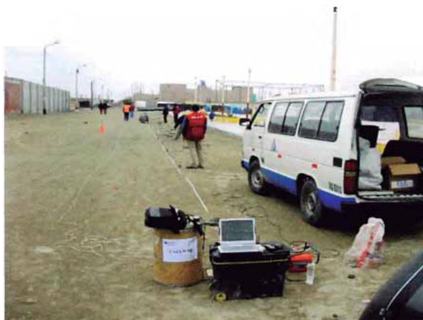
Fotografía No. 4. Vista panorámica de la línea sísmica del ensayo de MASW_06, en la Localidad de San Andrés ( 13^{\circ}43'59.70'' S, 76^{\circ}13'16.72'' W). Se aprecia el alineamiento de la línea de tendido.
