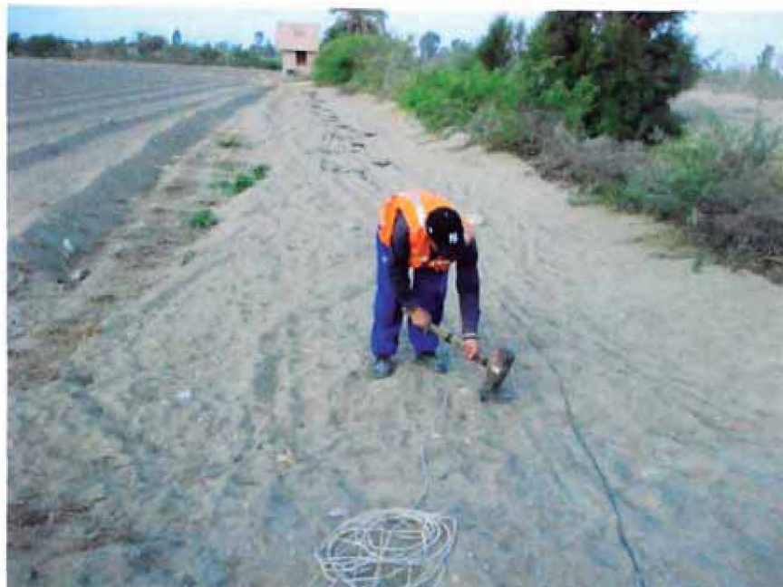
Fotografía No. 3. Vista panorámica de la línea sísmica del ensayo de MASW_05, en la Zona de Expansión ( 13^{\circ}43'32.59'' S, 76^{\circ}11'54.38'' W). Se aprecia la generación de la onda sísmica por el impacto del martillo.
