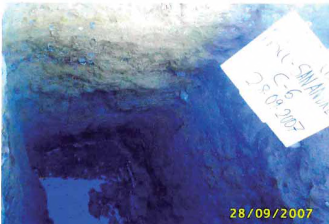
Fotografía No. 8. En la Calicata C-6: de 1.00 a 2.00 m Grava pobremente gradada con arena (GP). A 1.90 m de profundidad se encuentra el nivel freático
