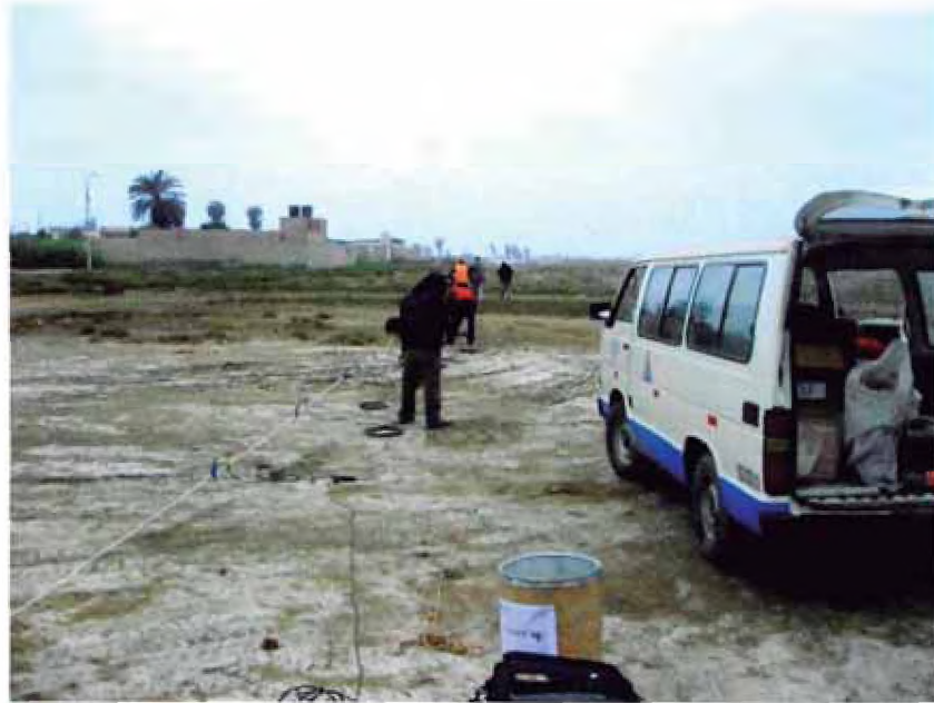
Fotografía No. 5. Vista panorámica de la línea sísmica del ensayo de MASW_07, en la Localidad de San Andrés ( 13^{\circ}43'31.91'' S, 76^{\circ}13'15.56'' W). Se aprecia el alineamiento de la línea de tendido.
