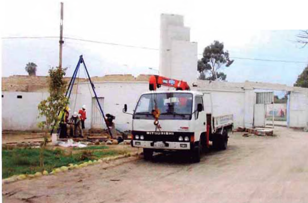
Fotografía No. 2. Extrayendo el tubo muestreador después de ejecutar el ensayo SPT.
