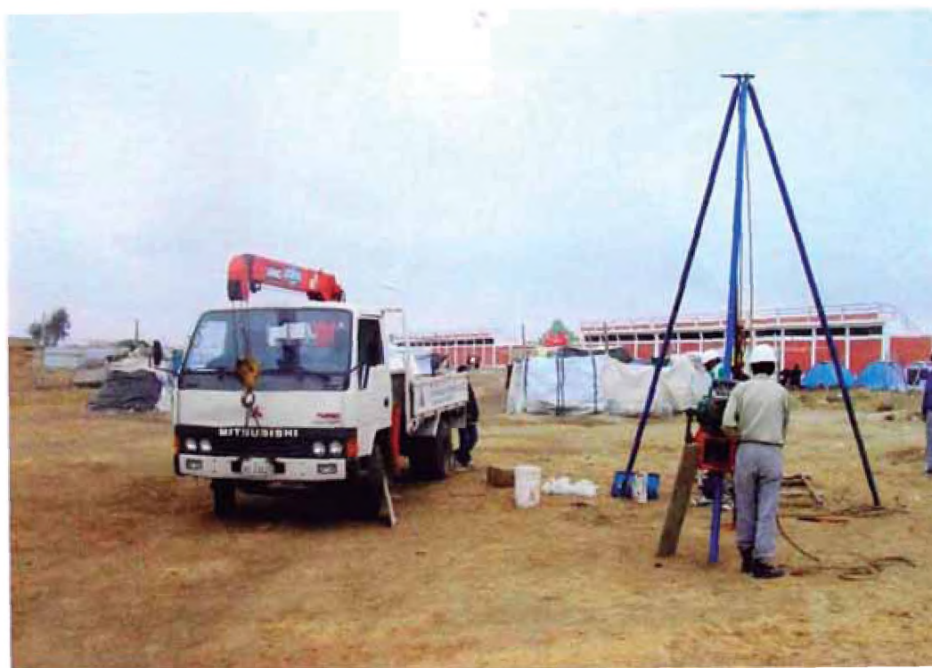
Fotografía No. 6. Ejecutando el Ensayo Penetración Estándar SPT en el Sondaje S-5.
