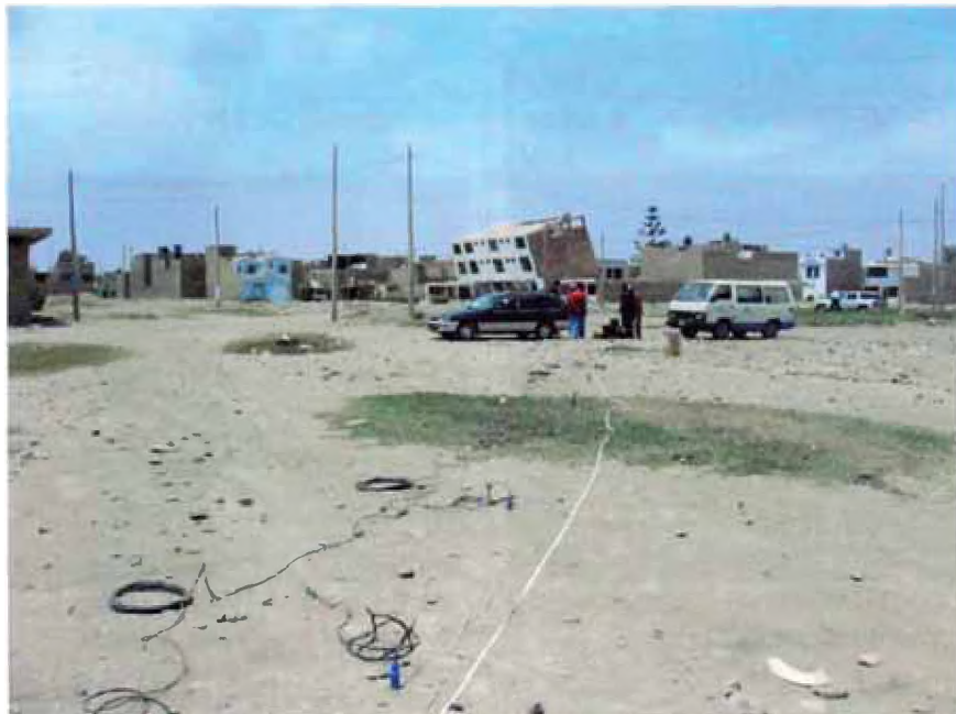
Fotografía No. 8. Vista panorámica de la línea sísmica del ensayo de MASW_10, en Pisco ( 13^{\circ}42'23.8'' S, 76^{\circ}12'33.2'' W).
