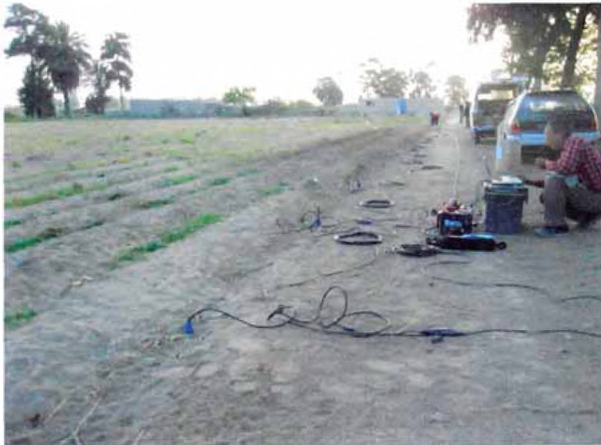
Fotografía No. 2. Vista panorámica de la línea sísmica del ensayo de MASW_04, en la Zona de Expansión ( 13^{\circ}44'23.28'' S, 76^{\circ}11'49.85'' W). Se aprecia los geófonos, conectores y adquisidor de ondas.
