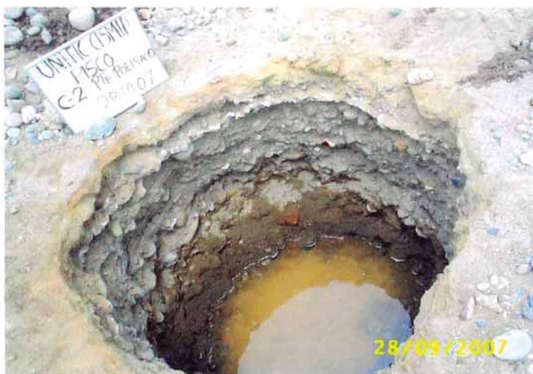
Fotografía No. 4. En la Calicata C-2: de 0.10 a 1.30 m Grava pobremente gradada con arena (GP). A 1.30 m de profundidad se encuentra el nivel freático.
