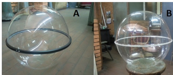
Figura 20: La esfera de alumbrado público con aro metálico que sirve para la unión (A); La misma esfera sin anillo metálico (B).
