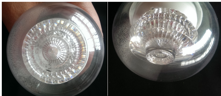
Figura 42: Imagen de la lámpara OSRAM donde se aprecia una extraña capa.
