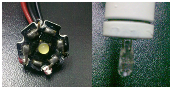
Figura 17: Lámparas usadas para la calibración de la esfera PCE-LED.
