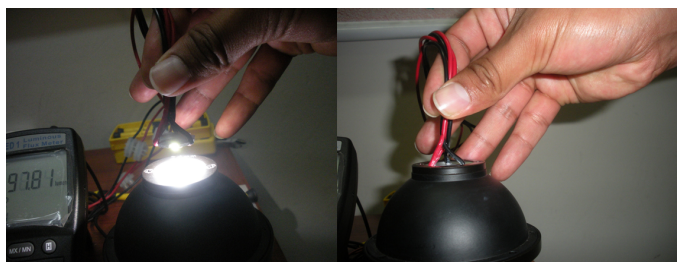
Figura 18: Proceso de evaluación de la lámpara LED5W usando la esfera PCE-LED.
