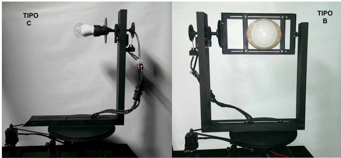
Figura 29: Los dos tipos de soportes con el que cuenta el nuevo goniofotómetro.
