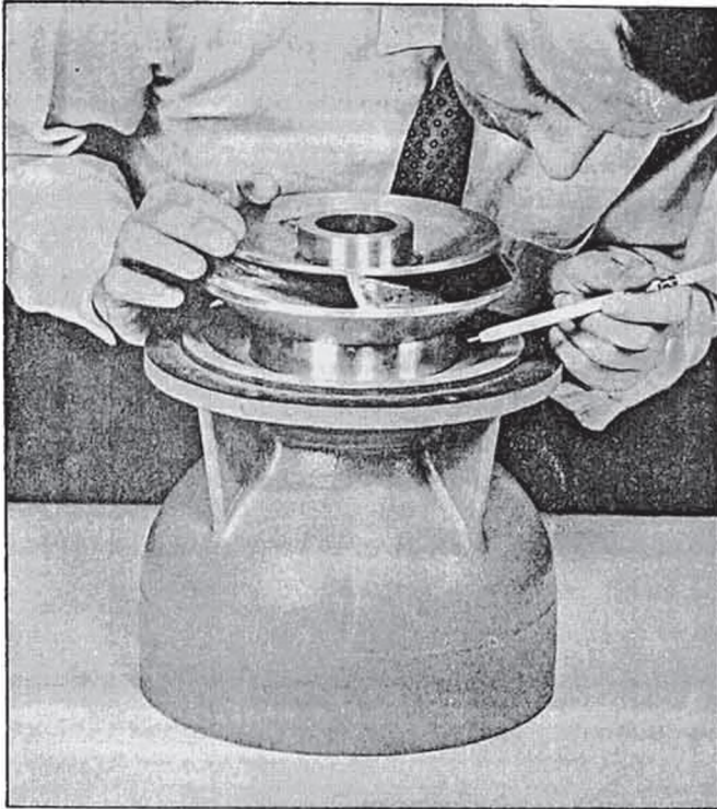
OBTURADORES EXTRALARGOS , entre la falda del impulsor y el tazón, proveen una obturación adecuada para compensar cualquier variación en el ajuste vertical.
