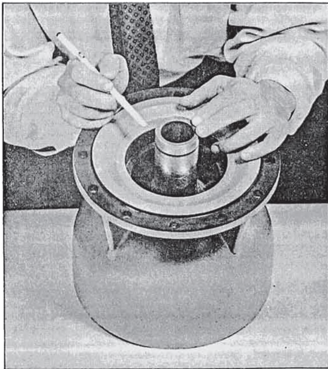
COJINETES EXTRALARGOS PARA EL TAZON SUPERIOR — ofrecen mayor soporte al eje en este punto crítico.
