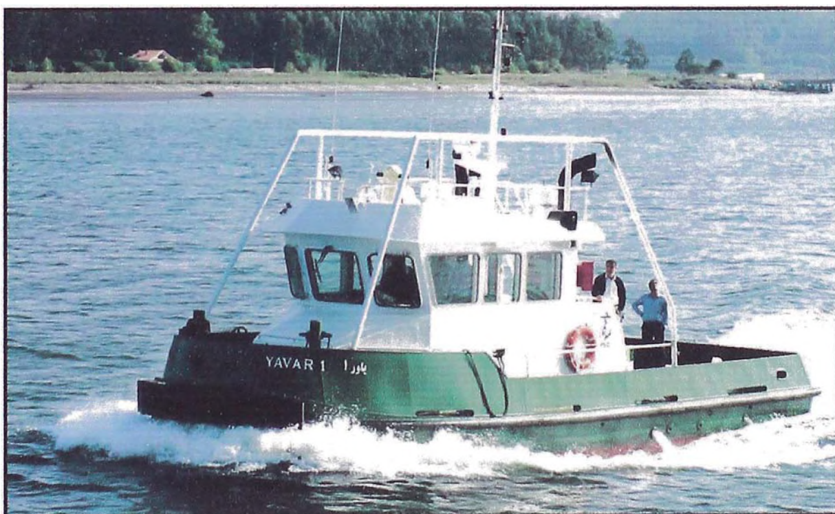
Figura n° 4.4 Yavar 1, Amarradora de 13.15m de eslora total.
