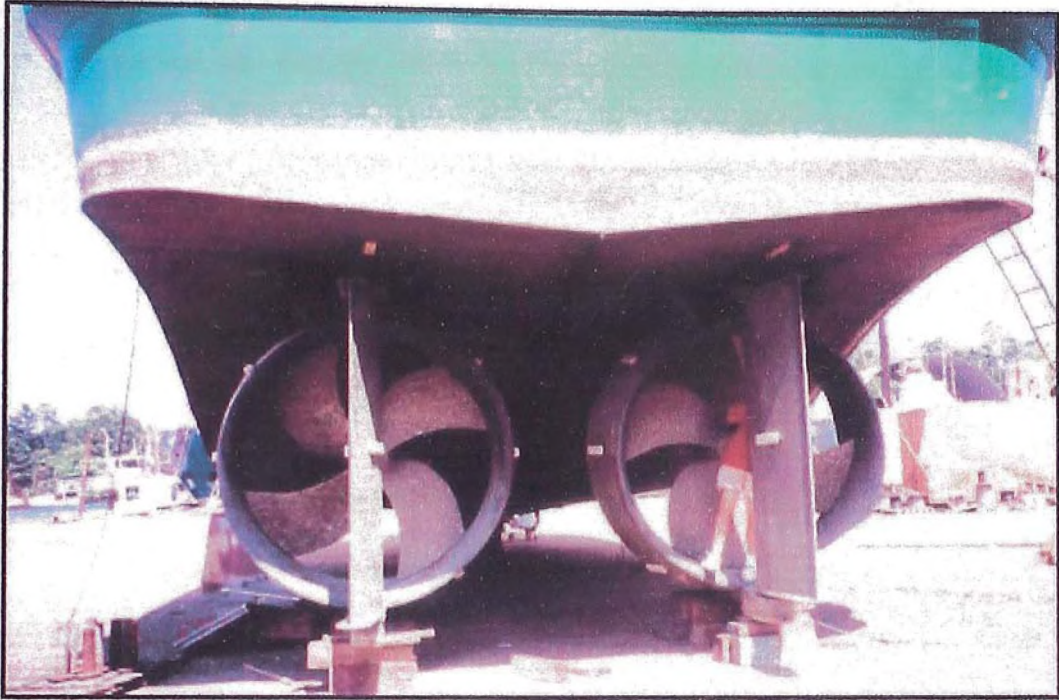
Figura n°5.12 Hélice con tobera con un timón.
