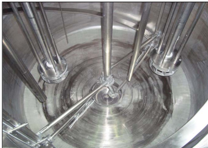
Figura 14: Agitación Helicoidal, paletas rastreadoras y Homogenizadores
