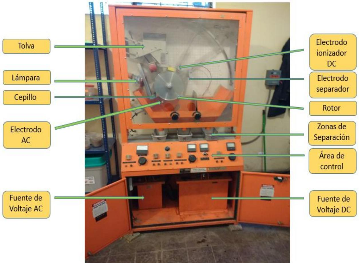
**Figura 3.6.** Partes del Separador Eléctrico CARPCO.
