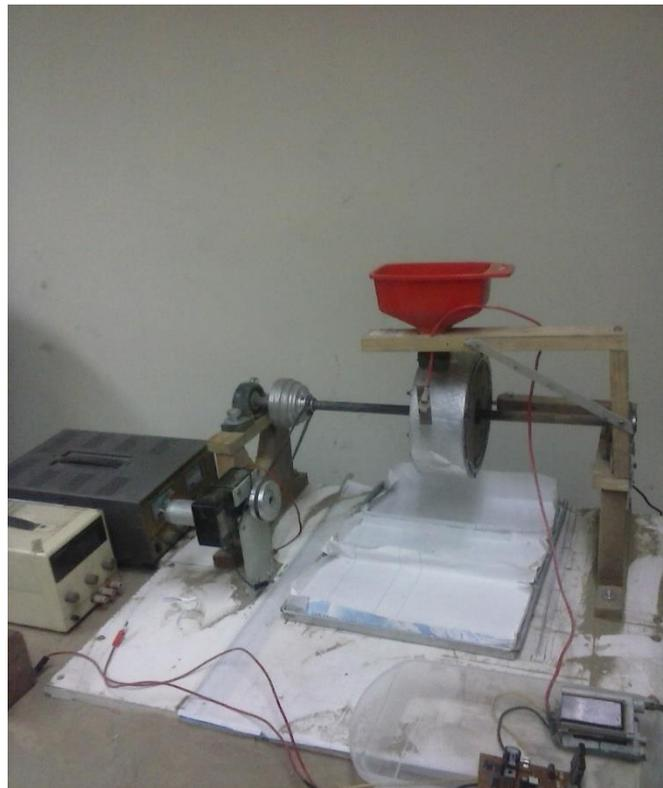
**Figura 3.4.** El prototipo separador eléctrico construido en la facultad de ciencias.
