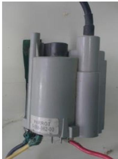
**Figura 3.1.** El Transformador Flyback que funciona con alta frecuencia (kHz).
