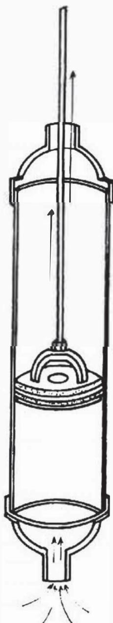
Fig. 2.8. Bomba artesanal con pistón metálico y empaquetadura de jete.
