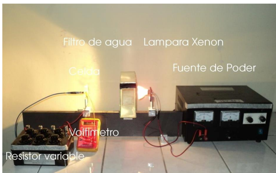
Fig. 14. Sistema experimental utilizado para la determinación de las curvas Corriente – Voltaje de las celdas preparadas.
