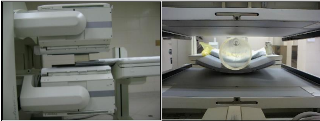
Figura 3.3 Maniquí de tiroides en la Cámara Gamma
