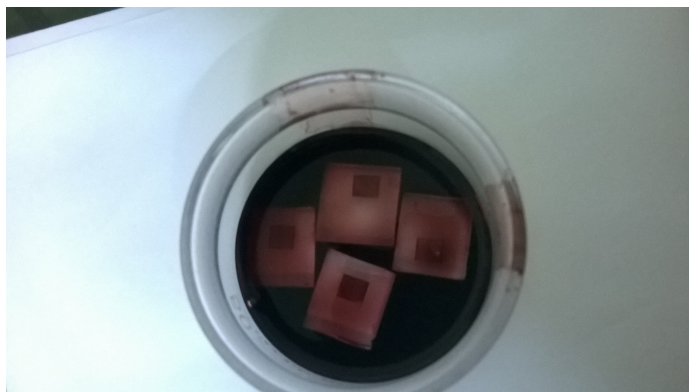
Figura 4.3: Imagen de las películas (foto-electrodos) sumergidos en el colorante N719
