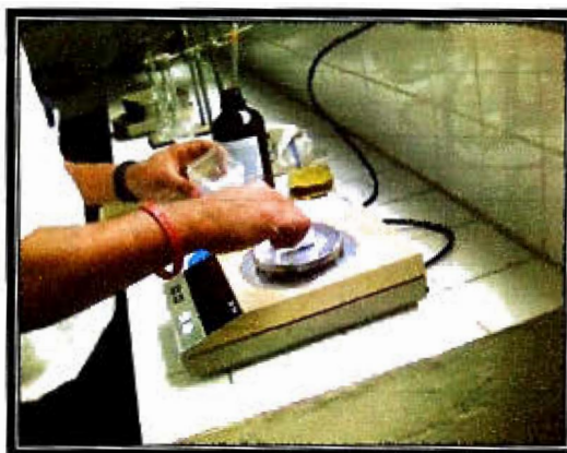
Foto 27: Pesado de aprox. 1.0 gr. de muestra mas 0.5 gr. de mezcla catalizadora ( K_2SO_4 + CuSO_4 en relación 10: 1 )
