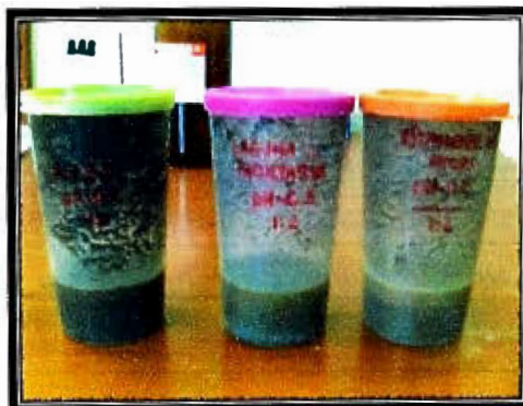
Foto 46: Dilución 1:2 de muestra con agua destilada, se tomo 25 gr. demuestra y se le agrego 50 ml de agua destilada.
