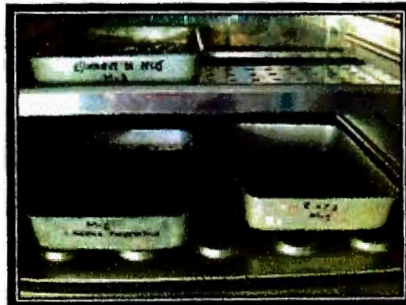
Foto 36,37,38: Secado de muestras poniendo a la estufa por 3 días a 80° C, para determinación de Carbono Orgánico Total
