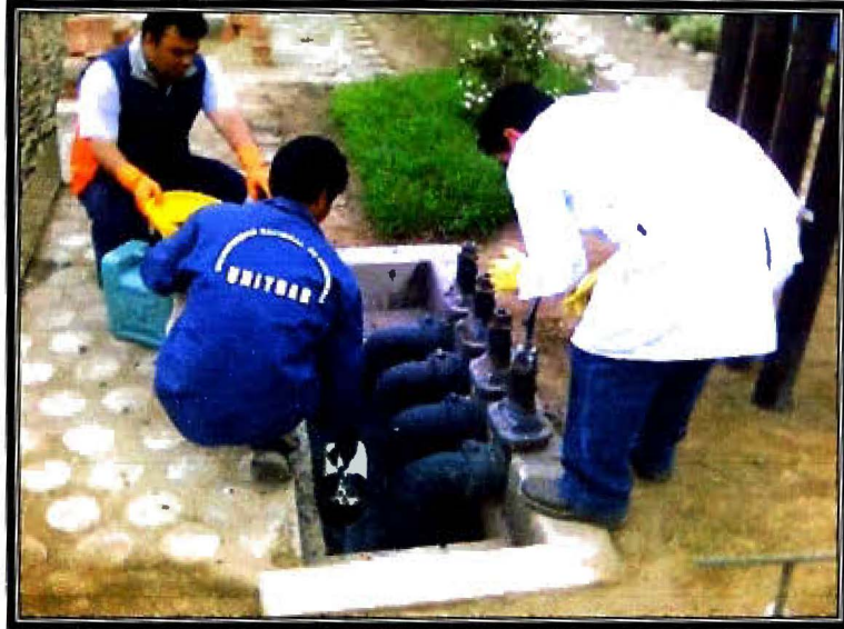
Foto 4: Toma de muestra de los lodos del R.A.F.A a h=1.50 m
