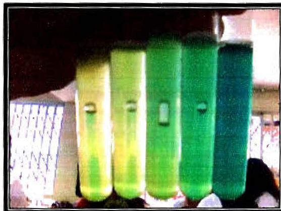
Foto 70: Presencia de gas en los tubos de ensayos para la determinación de Coliformes Fecales
