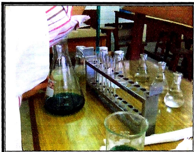
Foto 65: Preparación del Caldo Brilla y colocación del mismo en tubos de ensayo
