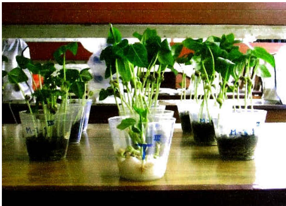
Foto 23: Diferencia de altura de plantines del LOTE III según el tipo de sustrato obtenido por cada lodo tratado.
