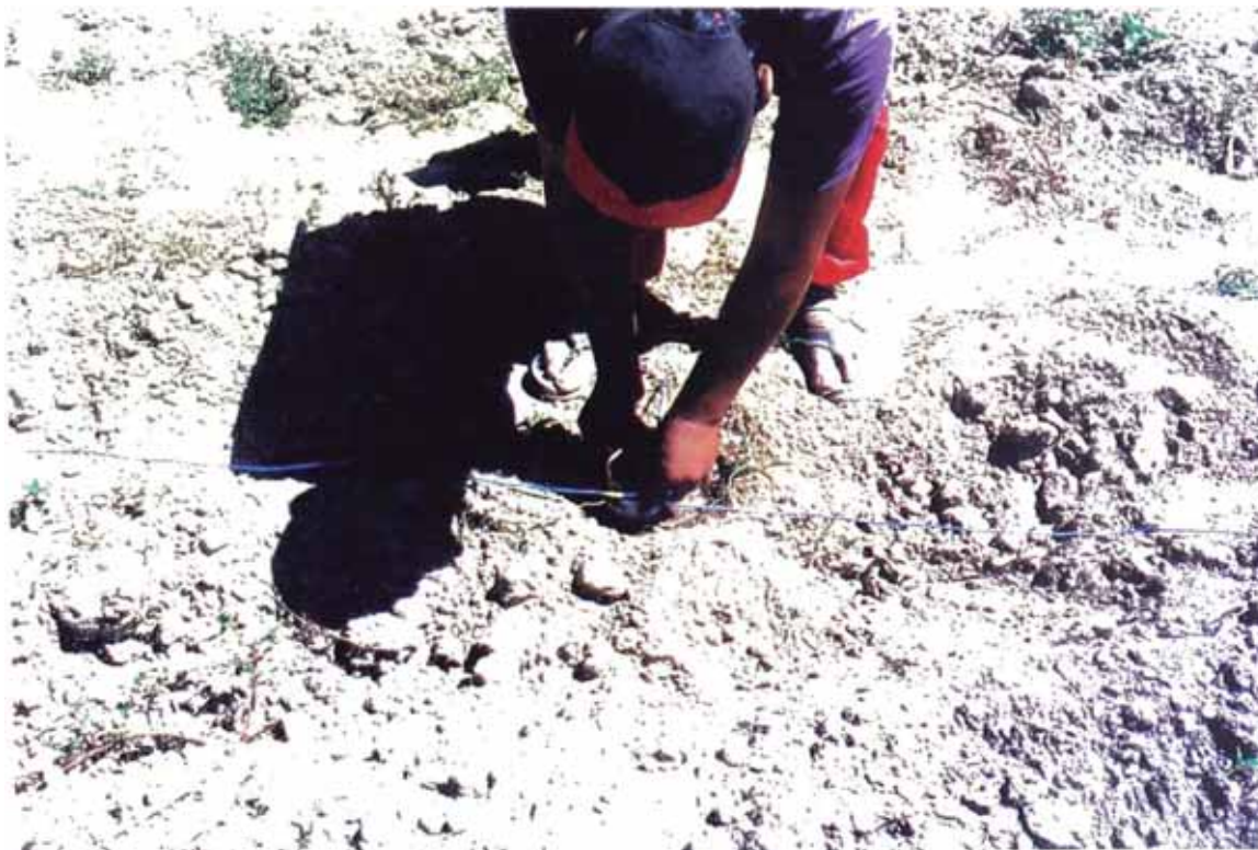
COLOCACIÓN DE ELECTRODOS DE MEDIDA EN TERRENO NATURAL
