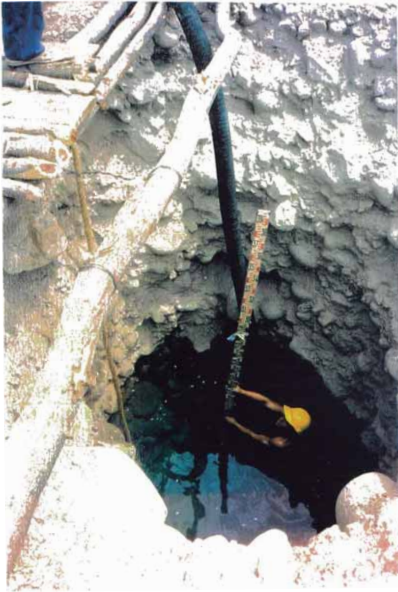
MEDIDA DE ABATIMIENTO EN PRUEBA DE BOMBEO CALICATA RÍO AJA
