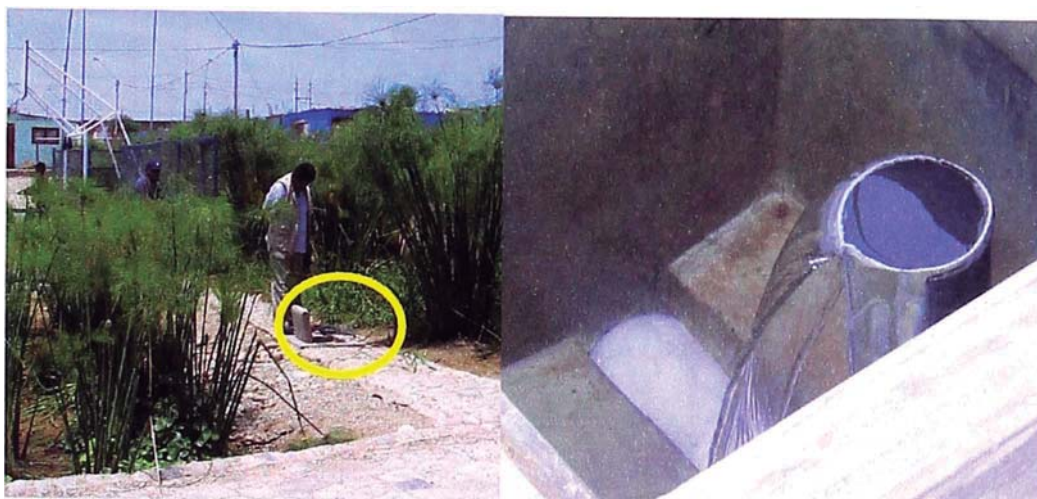
Foto 4.11: Izquierda: 2 do Punto de Muestreo "Ingreso al Humedal Subsuperficial" Derecha: 3 er Punto de Muestreo "Salida del Humedal Subsuperficial"
