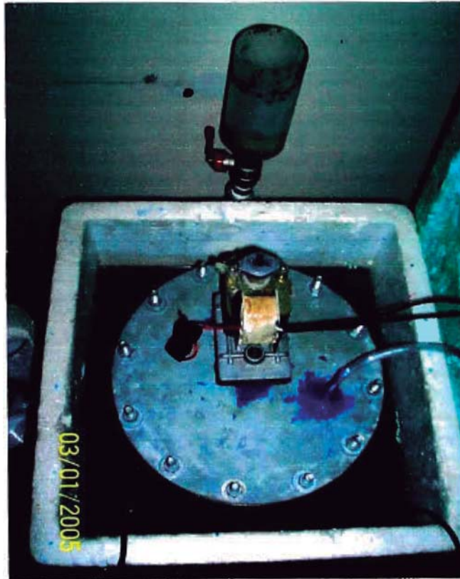
FIGURA 28.- REACTOR EN CAMARA AISLANTE PARA CUMPLIR CON LOS REQUERIMIENTOS DE TEMPERATURA
