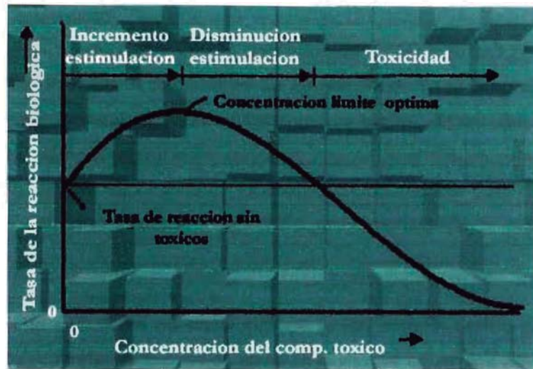
FIGURA 24.- EFECTO DE LA CONCENTRACIÓN DE UN COMPUESTO TÓXICO EN LA TASA DE REACCIÓN BIOLÓGICA
