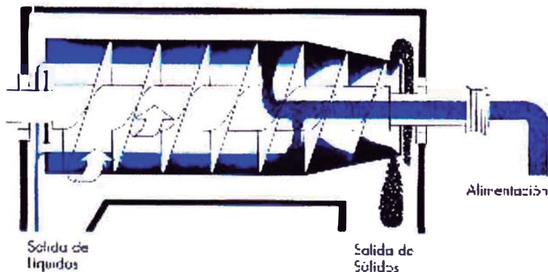
FIGURA 10. ESQUEMA DE FUNCIONAMIENTO DE LA CENTRIFUGA
