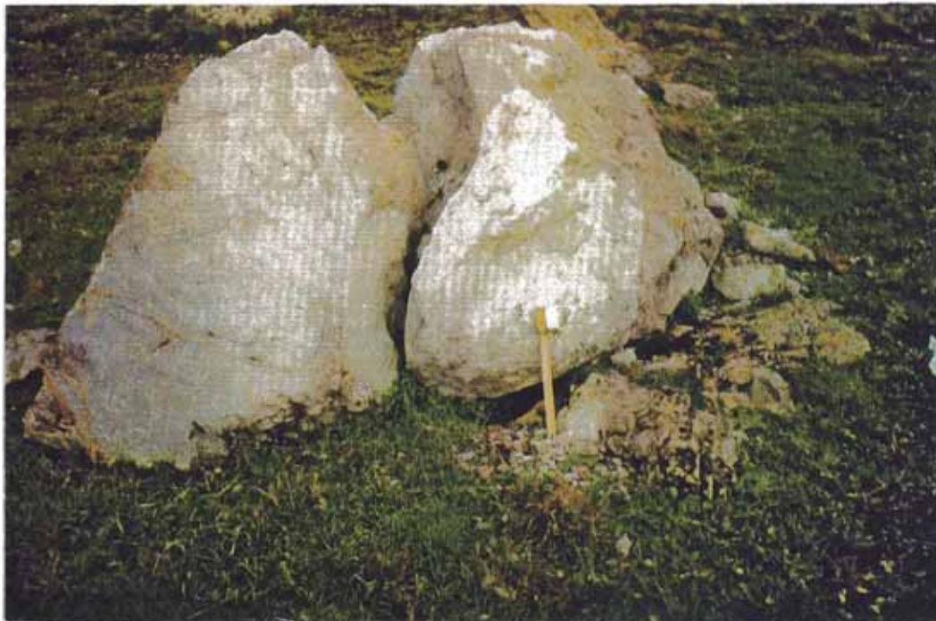
Foto N° 5.6: Presencia de lutitas, coloración amarillenta y gris verdosas en la superficie de las rocas producto del intemperismo.
