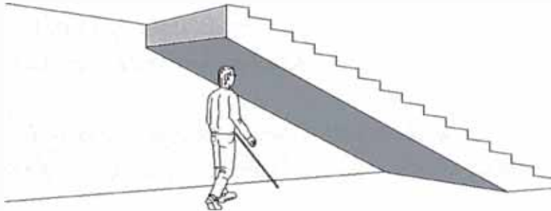
Figura N° 38: Forma incorrecta. Una evidente zona de alto riesgo.
