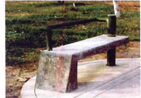
A lo largo de todo el recorrido del parque se ubica mobiliario, luminarias, tachos y bancas, estas últimas se trabajan en concreto y fierro, se busca un diseño práctico, duradero y que no requiera de mucho mantenimiento.
