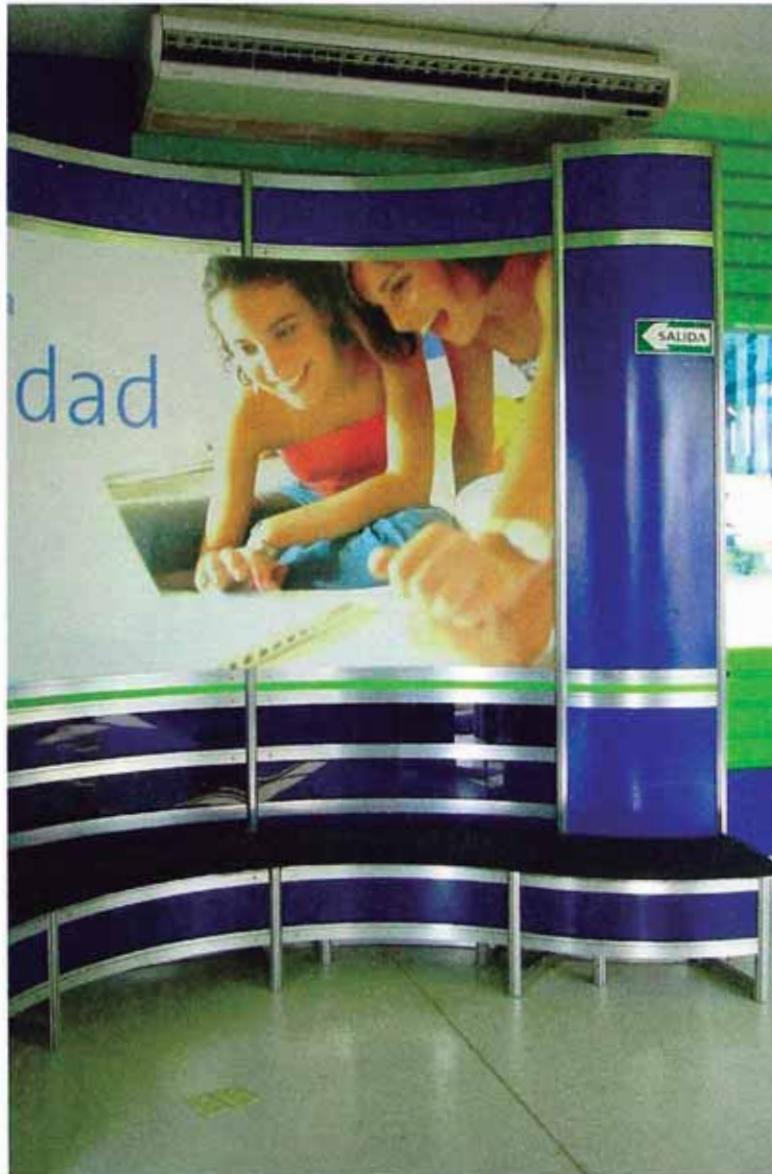
Vista del área de estar en la zona de Internet, diseñado y construido íntegramente en sistema octanorm: perfiles de aluminio curvo y paneles de nórdex con gráfica en acrílico retroiluminado.
