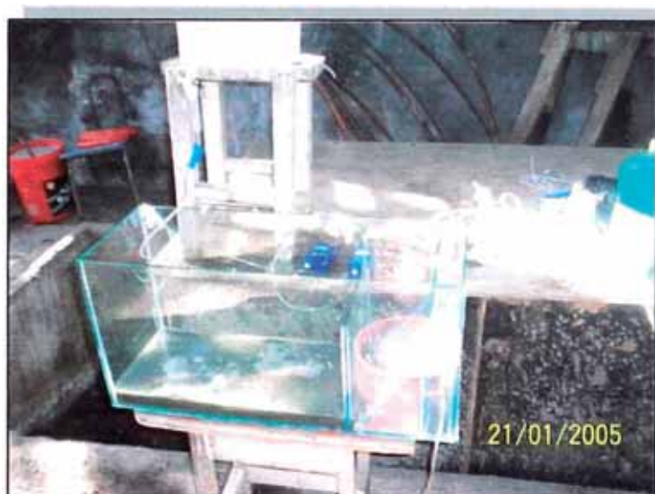
Foto N° 6.1.4.: Puesta en marcha de Planta de lodos Activados
