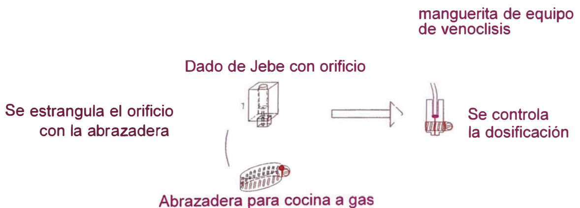
Fig. N° 4.6 Dispositivo de Control de Dosificación
