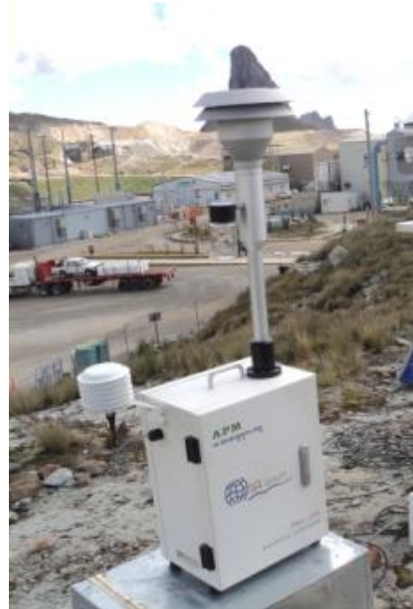
Figura 16 Muestreadores Activos Partículas PM2.5 (método de referencia)
