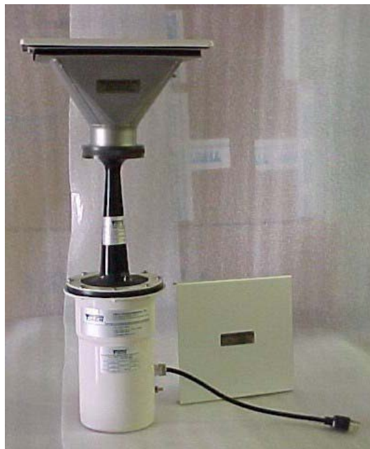
Figura 9 Componentes de un Hi Vol (motor, filtro, carcasa)
