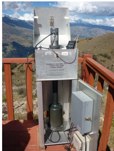
Lectura de presiones de un equipo Hi Vol
