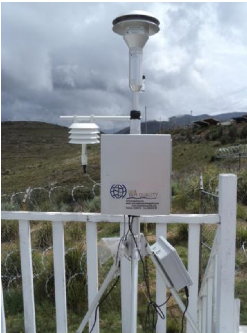
Figura 18 Muestreador continuo PM10 – EBAM (absorción Beta)
