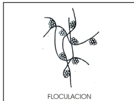
**Figura 2.9:** Mecanismos de acción de floculantes.
