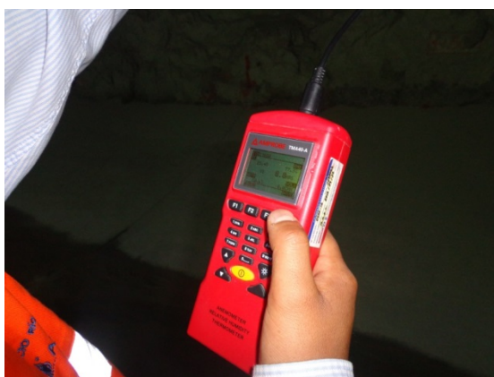
Figura 13: Equipo AMPROBE modelo TMA 40-A, utilizado para el levantamiento de datos (velocidad del aire, humedad y temperatura)
