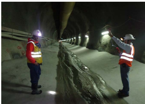
Figura 12: Levantamiento de datos en túnel de conducción (velocidad del aire, humedad y temperatura)
