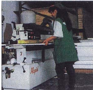
Colocación de tapacantos
