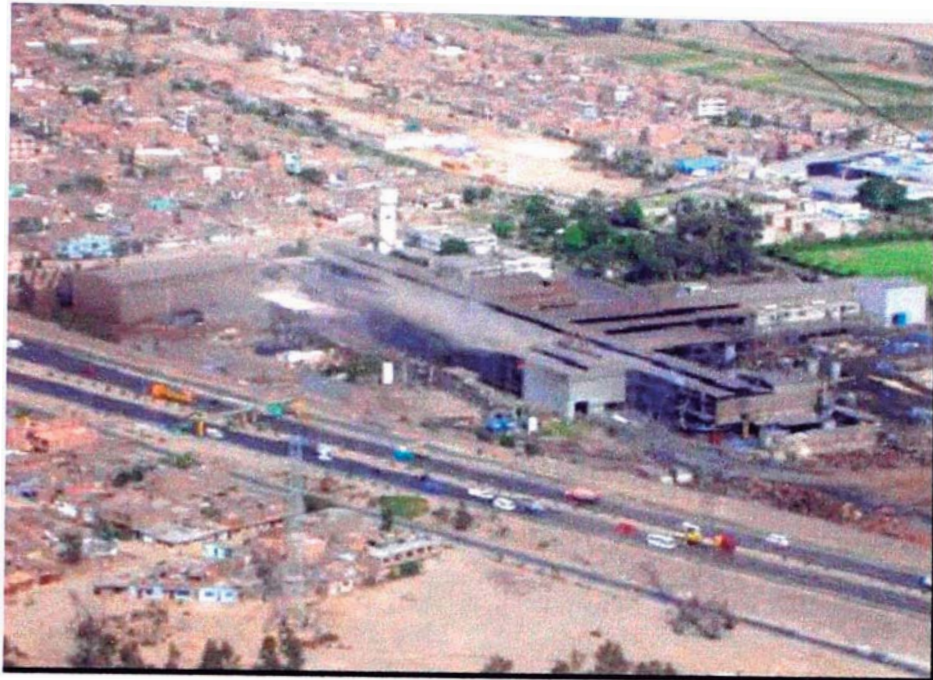
Foto 5: Fotografía tomada el 14 de febrero del 2002. Obsérvese emisiones fugitivas ostensiblemente visible de óxido de hierro, provenientes del sector de hornos.
