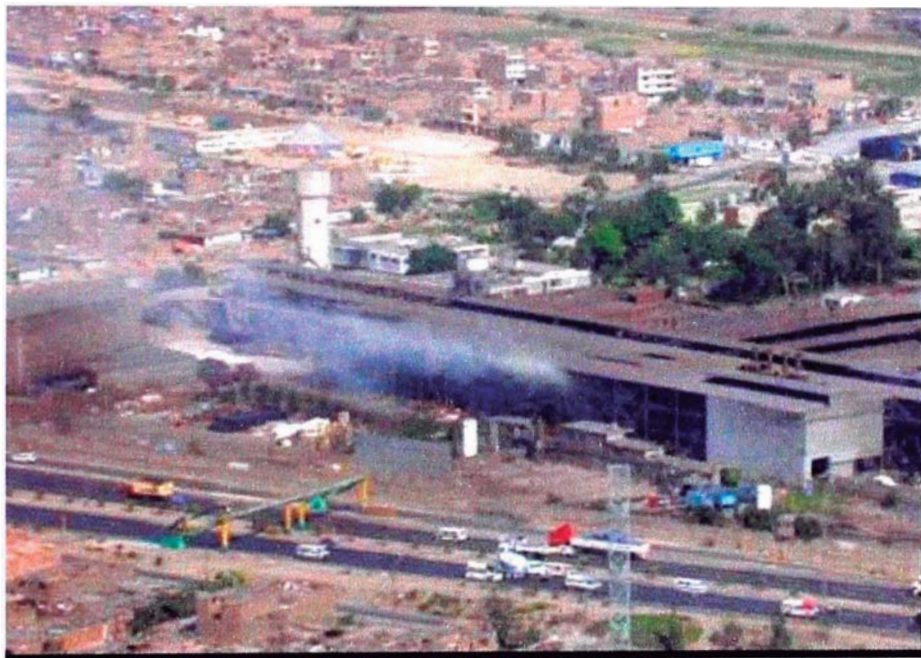
Foto 8: Fotografía tomada el 14 de febrero del 2002. Obsérvese emisiones fugitivas ostensiblemente visibles de dos coloraciones, primero gris y luego rojizo, provenientes del sector de hornos.
