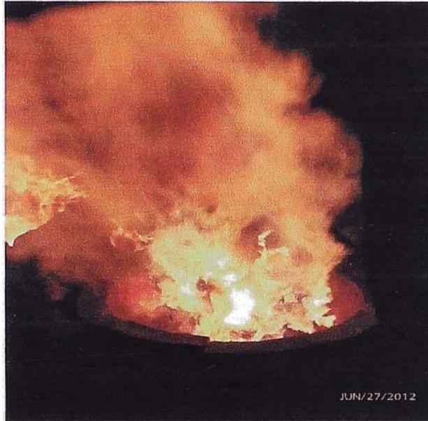
**Figura 3.7:** Llama de gas combustible con Incidencia en Tubos de la Zona de radiación de un Horno de Destilación a Vacío
