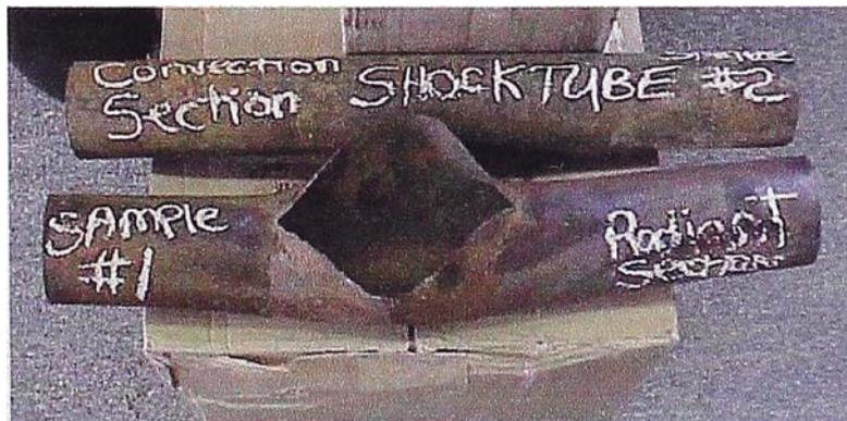
**Figura 3.16:** Tubo de la Zona Radiante que supero su Límite de Elasticidad
