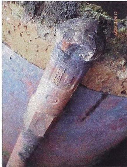
**Figura 3.1:** Boquilla de gas combustible en mal estado
