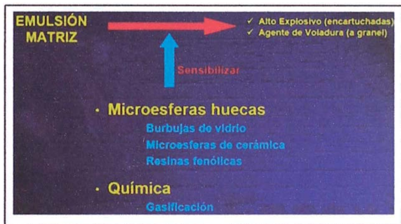
Fig. 5 Diagrama de elaboración de emulsión explosiva
