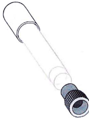
Muestreador pasivo para el dióxido de nitrógeno
