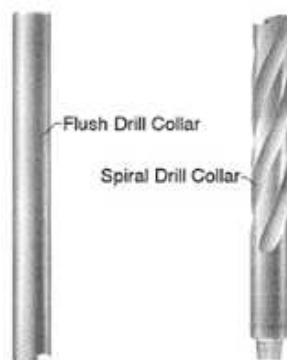
Figura 4 - 34: Drill Collar liso y espiralado
