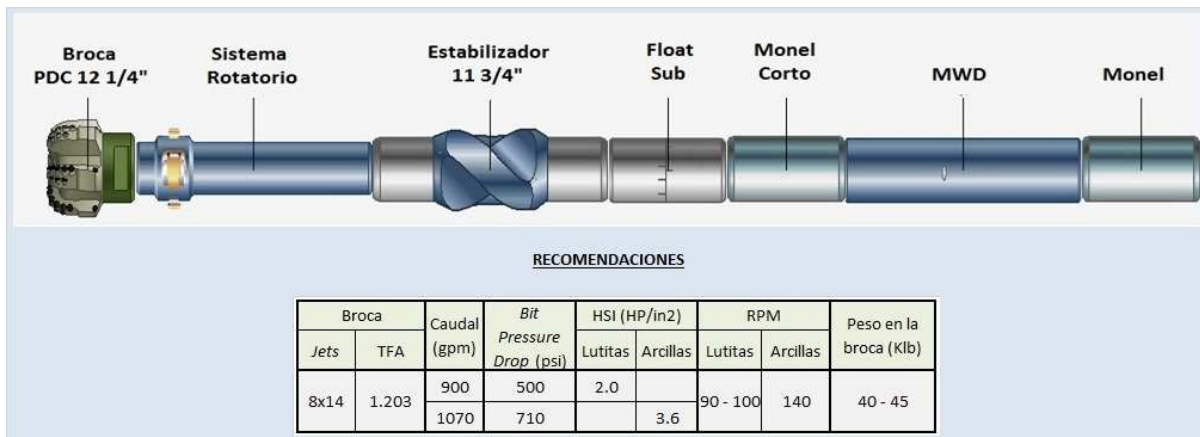
Figura 5 - 21: Propuesta de BHA con RSS & Parámetros Sección 12 1/4"
