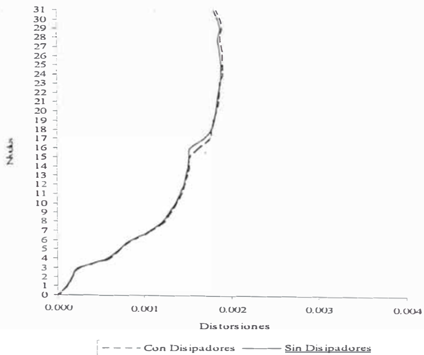
Figura 5.10 Distorsiones de entrepiso a 400 gals – eje Y
