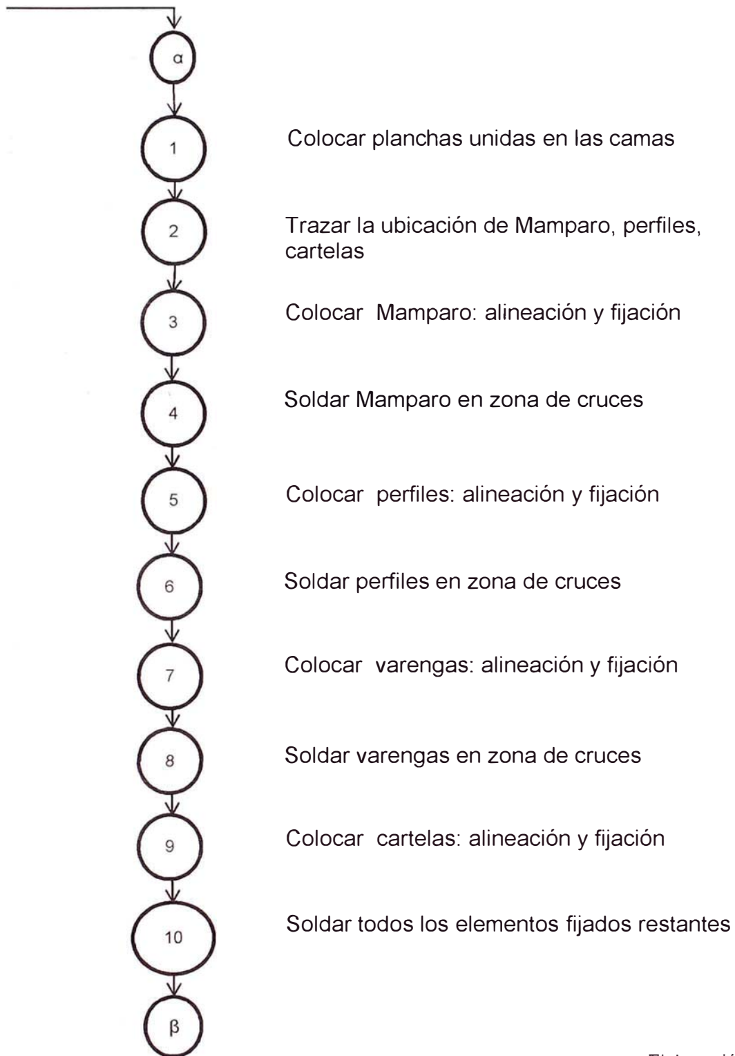
Diagrama N° 16 Diagrama de operaciones mejorado de ensamble de módulos
