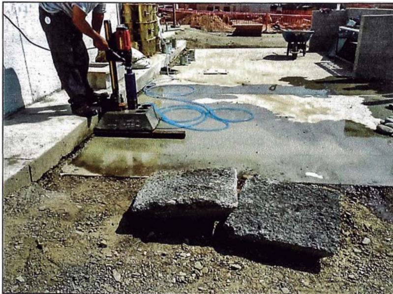
Figura N° 4.02: Extracción directa de las diamantinas de las bandejas tomadas en campo.
