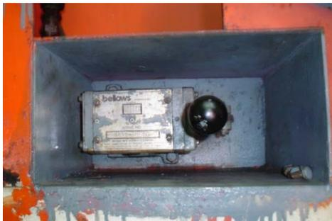
*Fig. 2.5 Control manual de la electroválvula de ingreso y salida del vástago*
