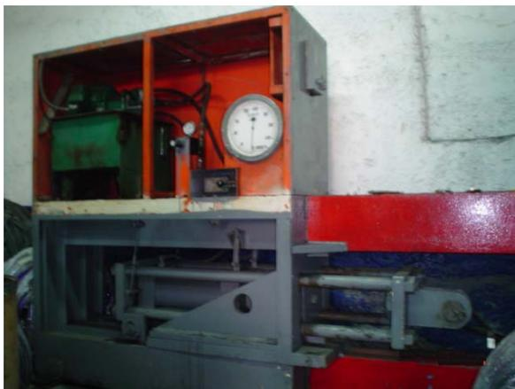
*Fig. 2.1 Cilindro hidráulico de control manual*
