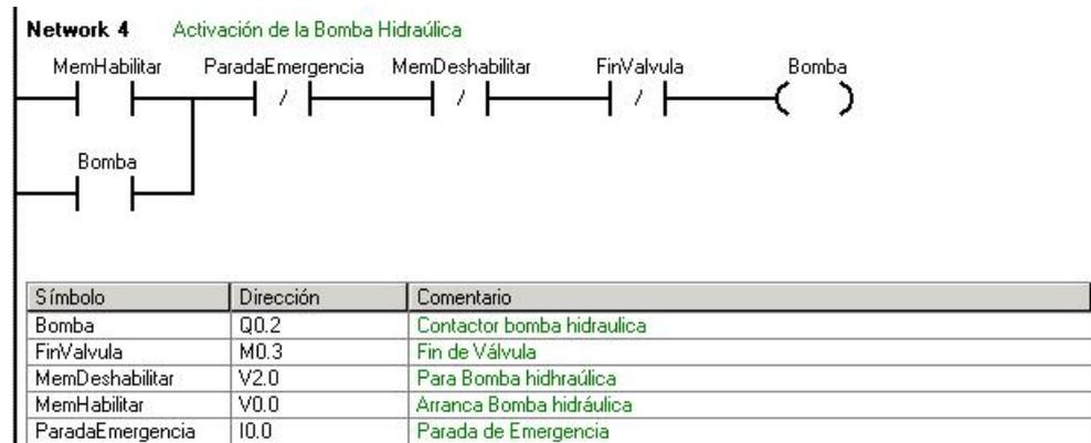
**Network 4** : Activación de la señal al contactor de la bomba
