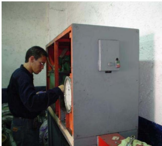
*Fig. 2.9 Operador con la máquina manual probadora de estrobos*
