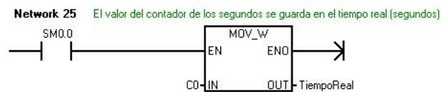
**Network 25** : El valor de los segundos alcanzados en la prueba se guarda en otra variable.
