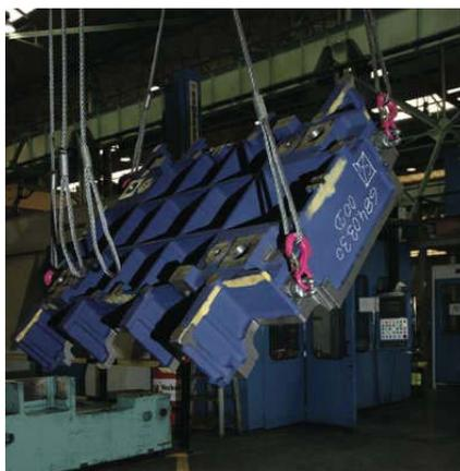
*Fig. 1.5 Uso del estrobo de acero: Sujetar maquinaria o equipos*
