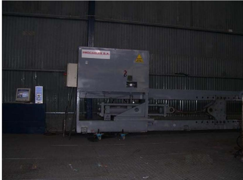
*Fig. 4.1 Máquina Probadora de Estrobos Automática.*
