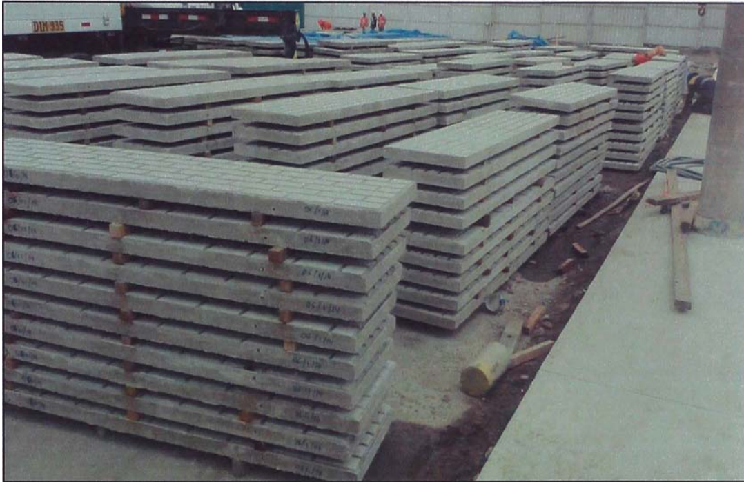
Figura N° 2.36. Paneles listos para su transporte a obra
