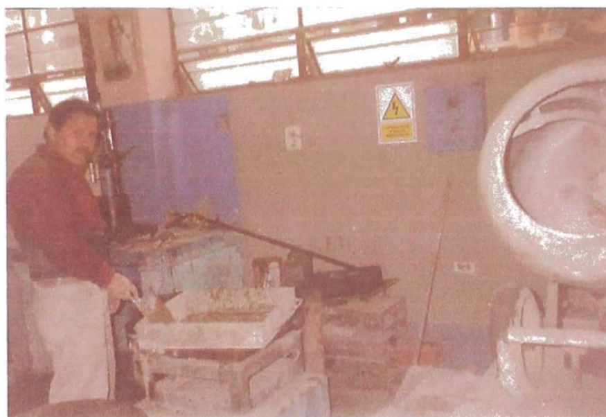
FOTO 13: TAMIZANDO POR MALLA 1/4" EL CONCRETO (PARA ENSAYO DE FRAGUA)
