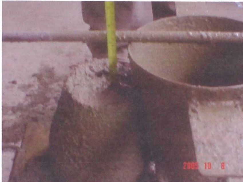
FOTO 10: ENSAYO DE ASENTAMIENTO CONCRETO FRESCO
