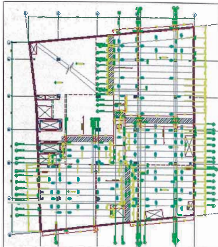
Fig. 39: Plano de postensado Fuente: Planos del proyecto.
